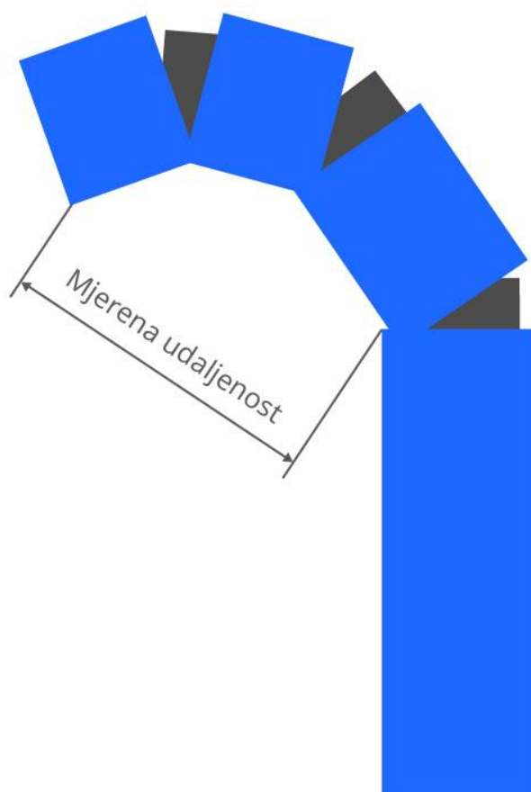
Slika 4.1. Mjerena udaljenost na mehatroničkoj šaci
