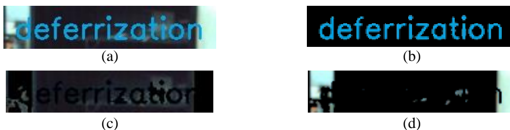
Sl. 3.1. Primjer grupiranja gdje je k = 3 . (a) Originalna slika, (b) grupa koja sadrži tekst, (c) prva grupa koja sadrži pozadinu, (d) druga grupa koja sadrži pozadinu.
