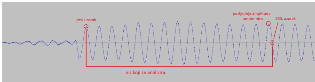
Slika 3.2.5. Način detekcije zvučnog signala
