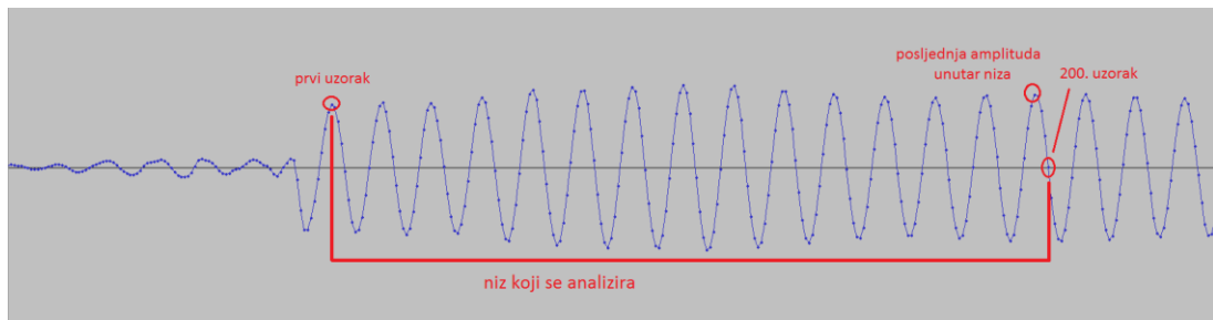
Slika 3.2.5. Način detekcije zvučnog signala
