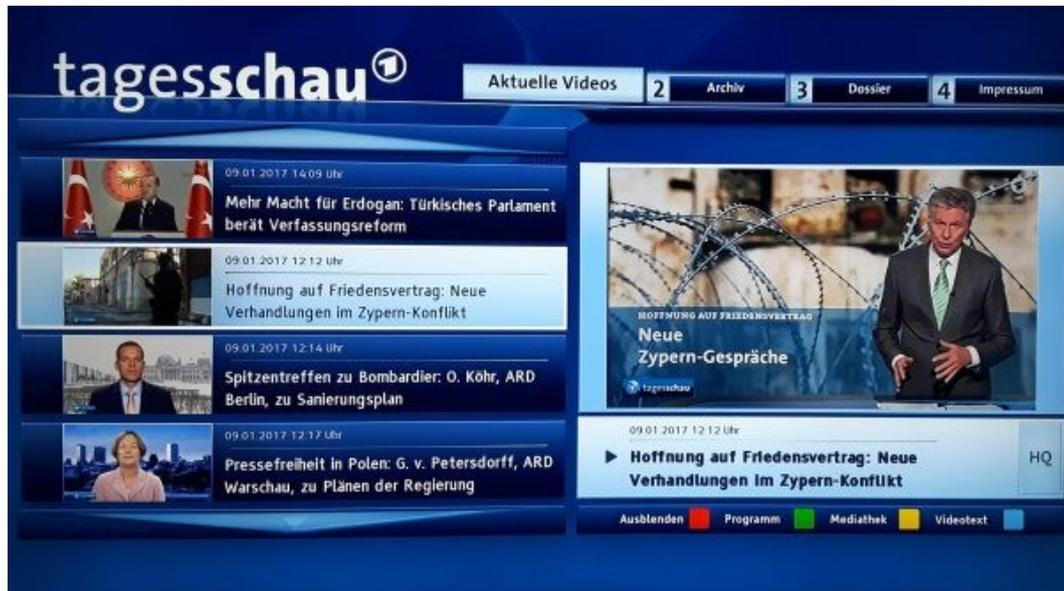
Slika 2.1.2. Izgled elektronskog programskog vodiča na HbbTV uređaju [3]
