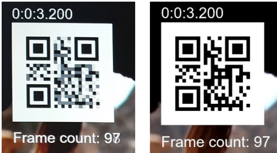
SI 3.8. Primjer nečitljivog QR koda (lijevo) i čitljivog koda (desno)
