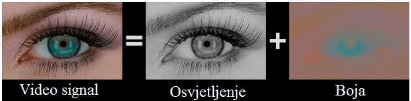
Sl. 2.3. Rastavljanje video signala na svjetlosnu i komponentu boje [5]
