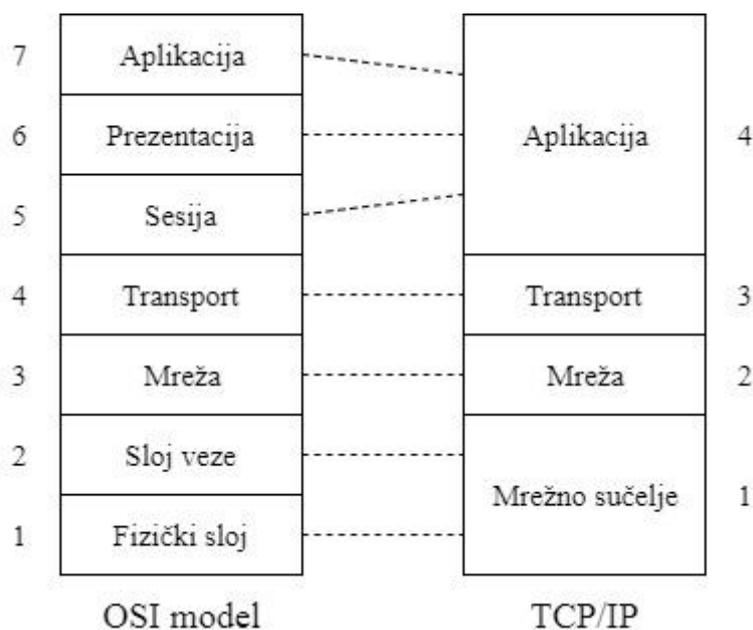
**Slika 2.1.** Usporedba TCP/IP s referentnim OSI modelom [1]
