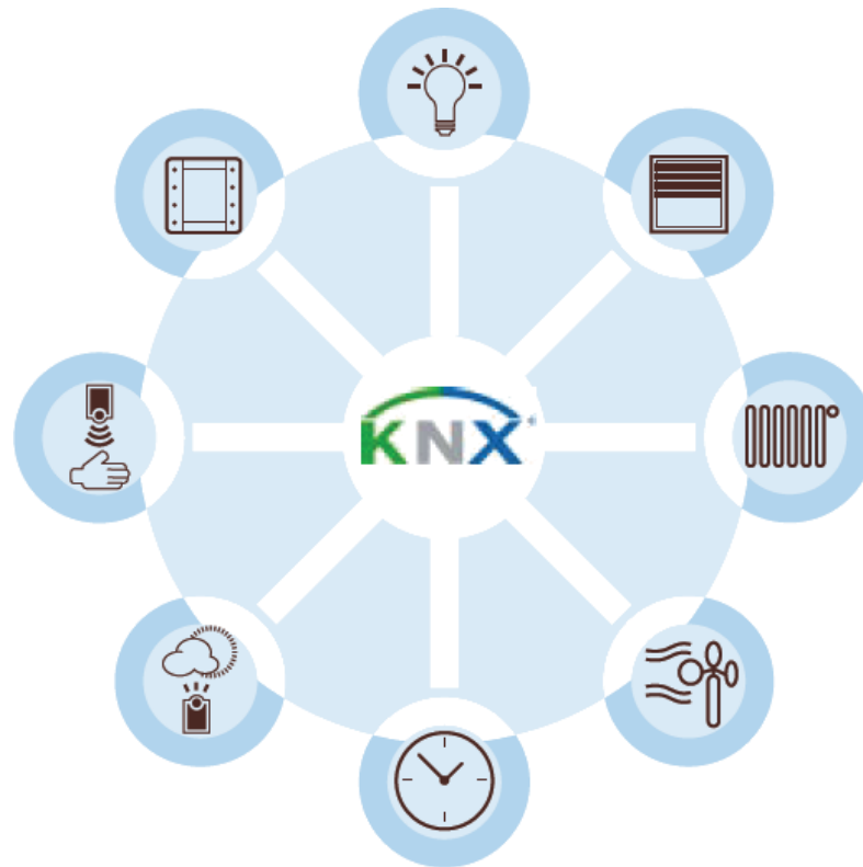
Sl. 2.2. Slika prikaza mogućnosti nadzora sustavom KNX[13]
