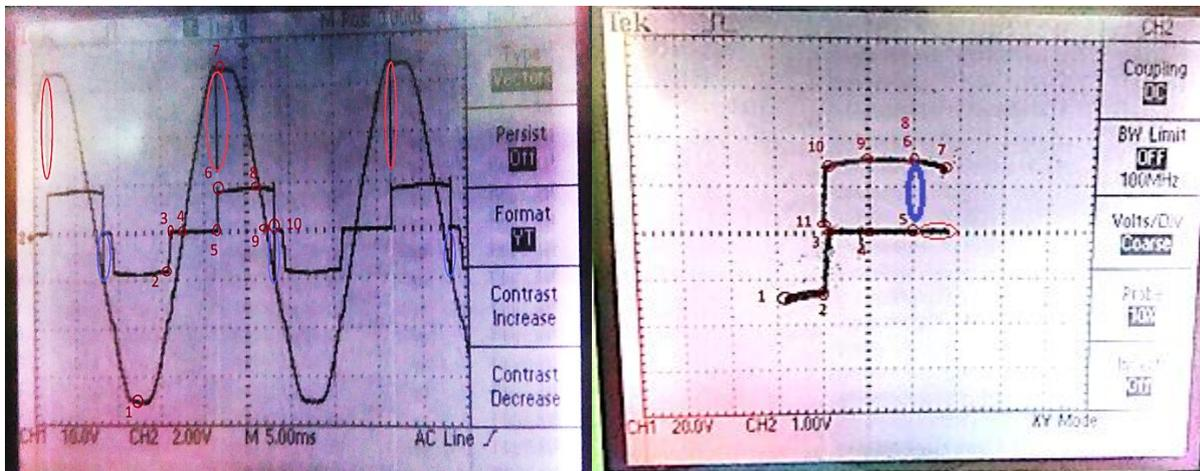
*Slika 3.12. Valni oblik napona i struje faze (lijevo) i  $u-i$  karakteristika (desno) za kut upravljanja  $\alpha=60^\circ$*
