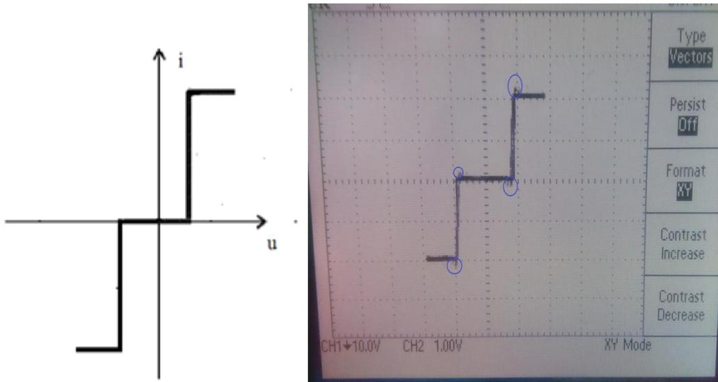
**Slika 3.4.** Analizirana  $u-i$  karakteristika (lijevo) i mjerena  $u-i$  karakteristika (desno)
