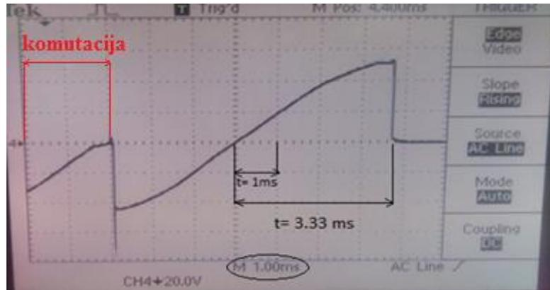
*Slika 3.5. Interval napona ventila za  $\alpha = 60^\circ$*
