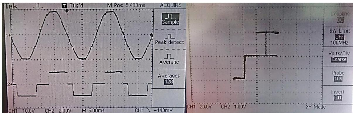
**Slika 3.17.** Valni oblik napona i struja faze sa postavkama dots i sample (lijevo) i  $u$ -i karakteristika (desno) za kut upravljanja  $\alpha = 30^\circ$
