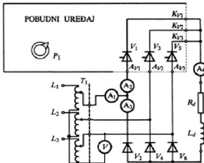
*Slika 3.2. Shema spajanja poluupravljivog ispravljača u mosnom spoju [2]*
