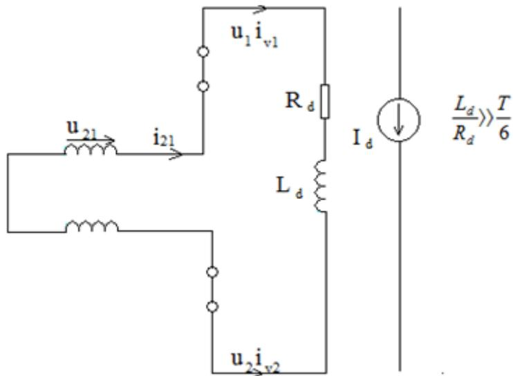
Slika 2.6. Nadomjesna shema za određivanje struje  $i_{21}$
