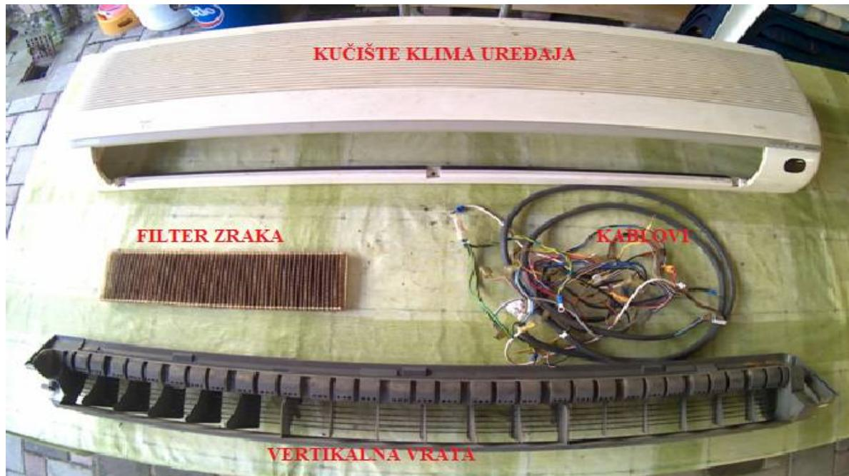
Slika 4.4. Dijelovi klima uređaja
