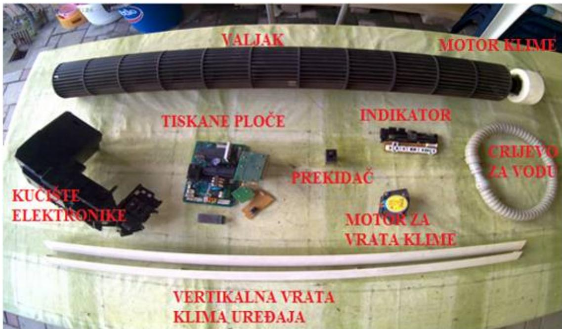
**Slika 4.6.** Prikaz pojedinih rastavljenih dijelova klima uređaja
