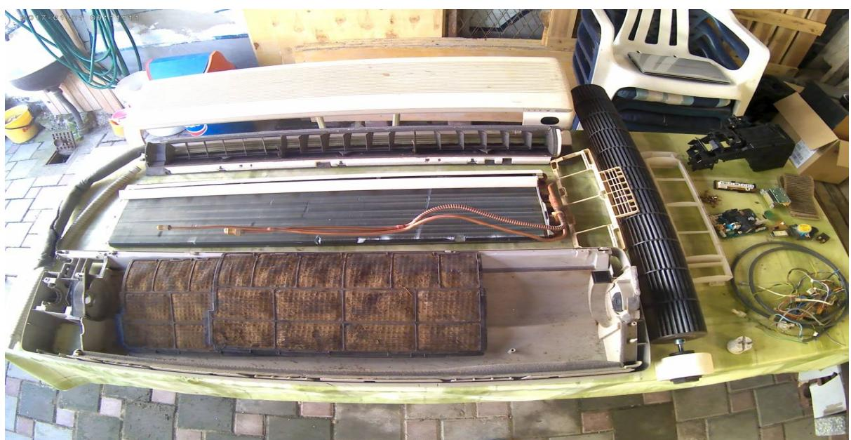
**Slika 4.3.** Rastavljena unutarnja jedinica klima uređaja
