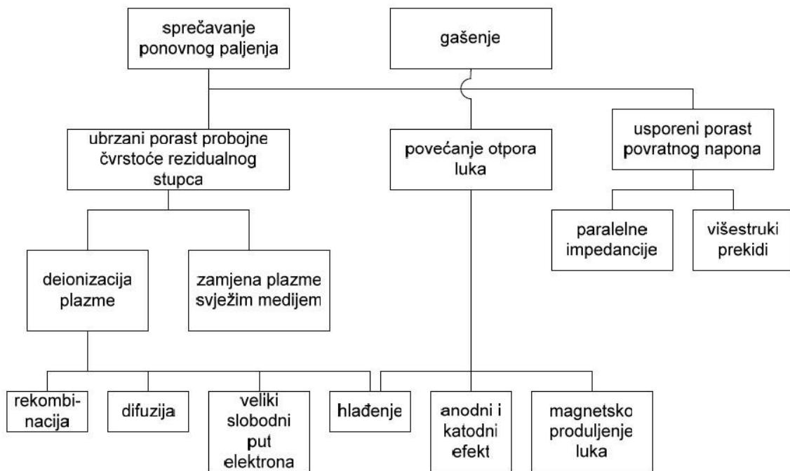
*Slika 3-4. Sustavi gašenja električnog luka*<sup>7</sup>
