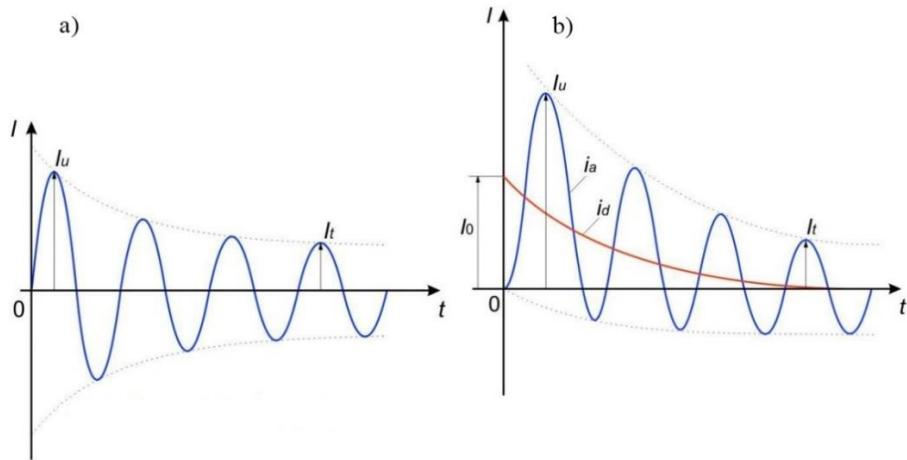
*Slika 2-8 Karakteristike kratkog spoja – a) Simetrična i b) asimetrična struja kratkog spoja <sup>2</sup>*
