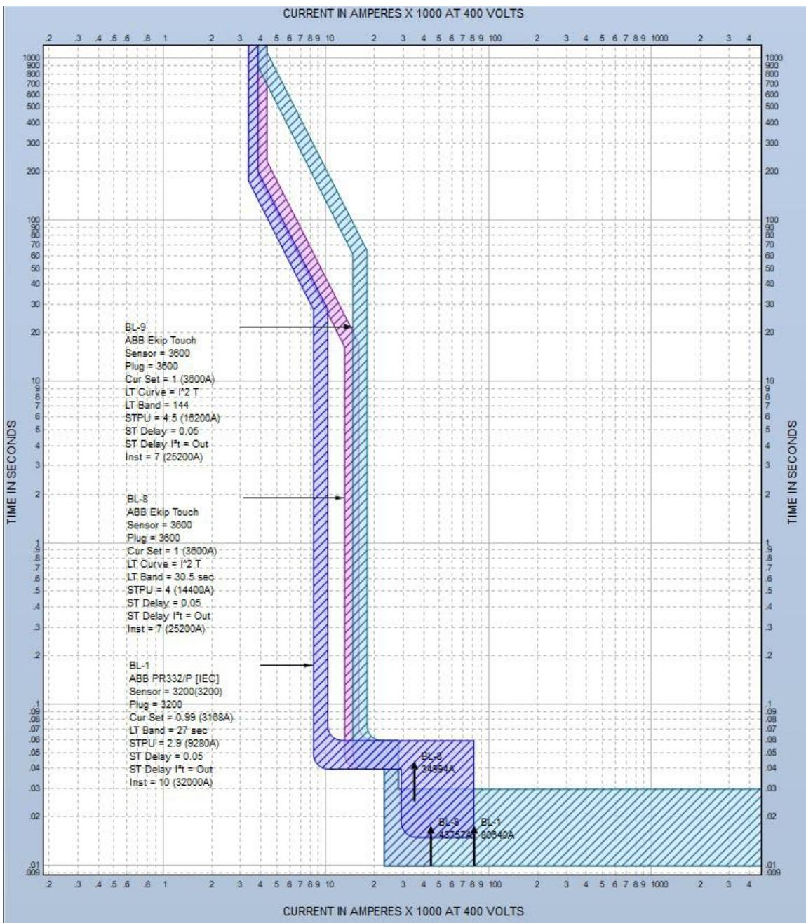
**Slika 5-11 Karakteristike prekidača na BUS-BIO, BUS-4K i BUS-MR1**
