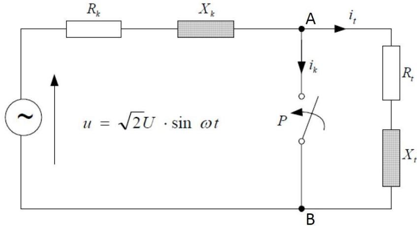
*Slika 2-7 Nadomjesni strujni krug za analizu kratkog spoja<sup>1</sup>*
