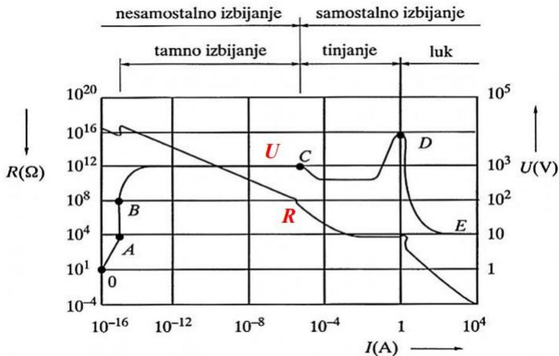
*Slika 3-3 Karakteristika napona i otpora električnog luka u ovisnosti o struji<sup>6</sup>*
