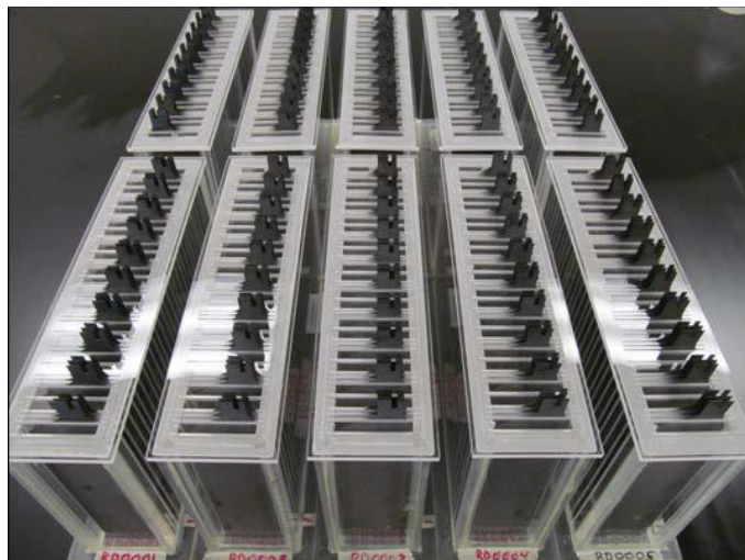
Slika 6.14. Prototip cink-zrak baterije [4]
