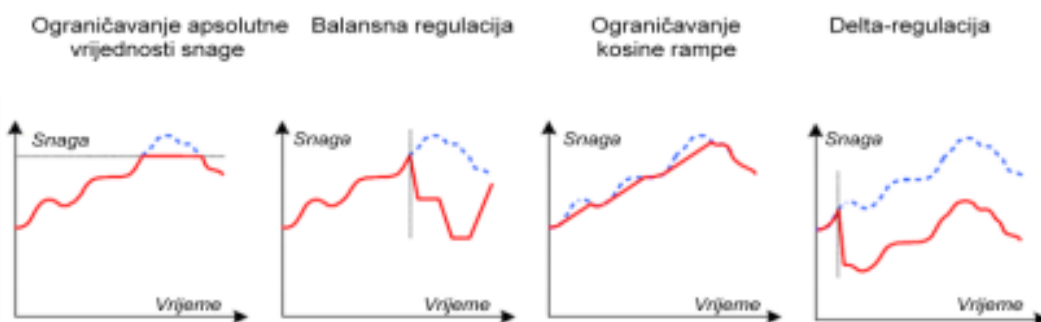
Slika 6.2.Principi funkcija regulacije djelatne snage [15]
