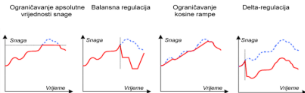
Slika 6.2.Principi funkcija regulacije djelatne snage [15]
