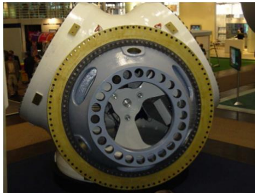
Slika 2.5. Glavčina vjetroagregata snage 1.5 MW [10]
