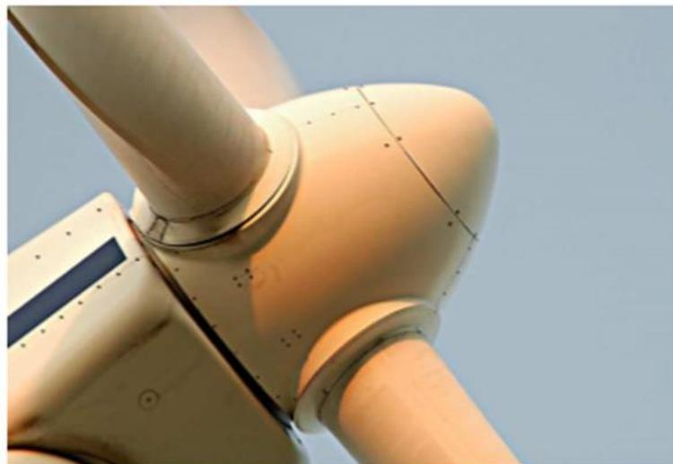
Slika 3.1: Stacionarni mirujući i rotirajući dio oplate vjetroagregata [2]
