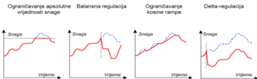
Slika 6.2.Principi funkcija regulacije djelatne snage [15]
