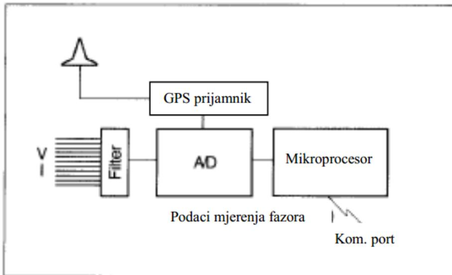
Sl. 4.8. Blok shema sinkronizirane mjerne jedinice [19]
