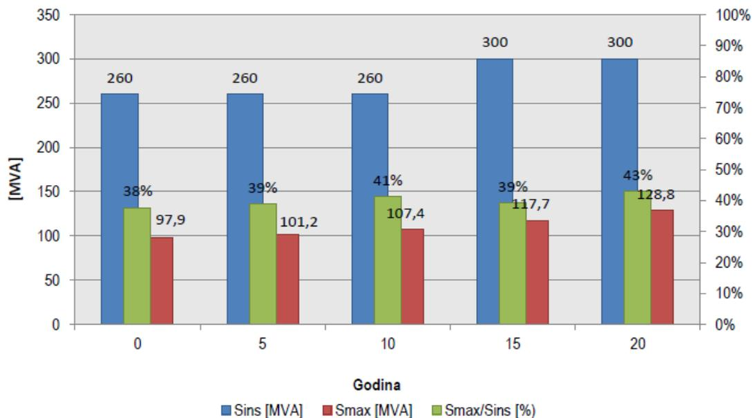
Sl. 5.6. Iskorištenost transformacije 110/35 kV i 110/10(20) kV [21]
