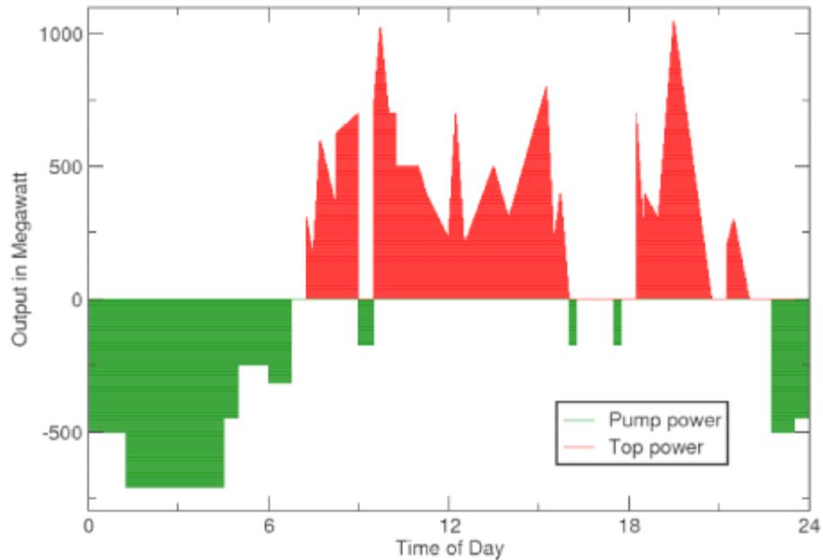
Sl. 4.5. Tipični dnevni režim rada crpno-akumulacijske elektrane [15]
