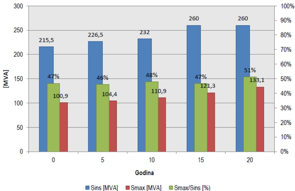
Sl. 5.7. Iskorištenost transformacije 110/10(20) kV i 35/10(20) kV [21]
