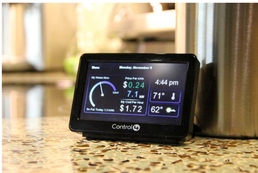
Slika 2.7. Izgled kontrolne jedinice za pregled potrošnje
