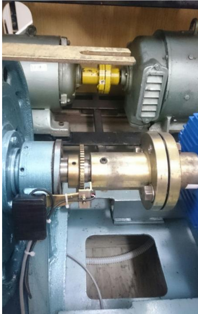
Sl. 4.4 Prikaz inkrementalnog enkodera koji se nalazi na fakultetu
