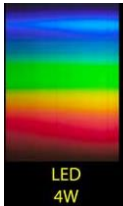
Slika 2.1. Spektar boja LED žarulje. [2]
