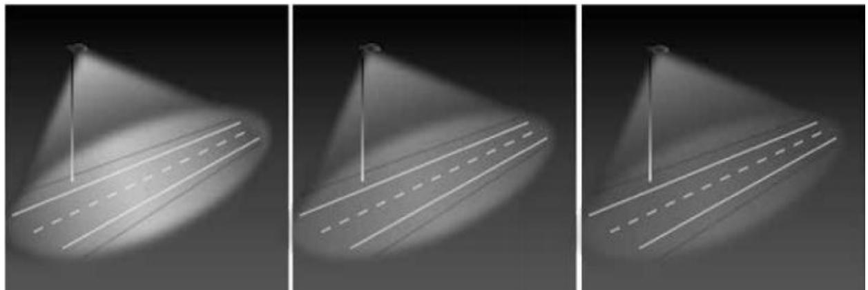
*Slika 5.9 LED rasvjeta prilikom kvara pojedinih modula (kada svaki modul osvjetjava cijelu površinu pokrivenosti svjetiljke).*
