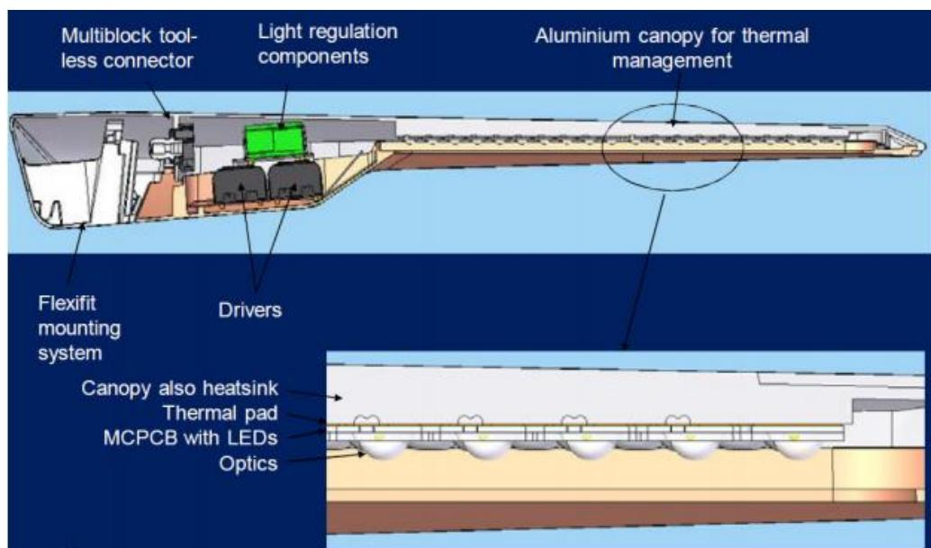
Slika. 5.6 Philips SpeedStar svjetiljka za javnu rasvjetu (dijelovi)[10]
