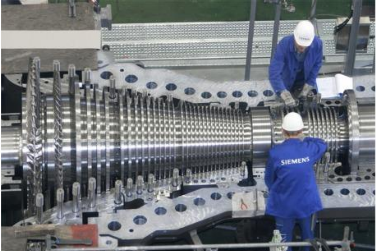
Sl.2.8. Parna turbina [8].
