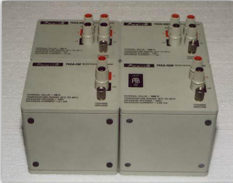
Slika 4 Etalonski otpornik proizvođača Fluke, [6].
