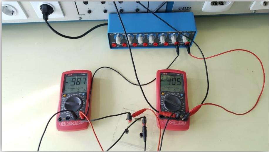
**Slika 15 Shema spoja usporedbene metode u laboratoriju.**
