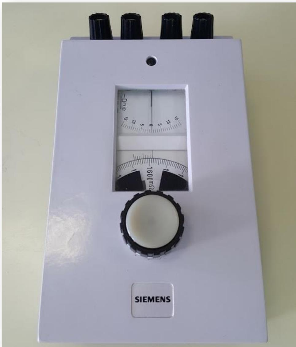
**Slika 16 Laboratorijska izvedba Thomsonovog mosta.**
