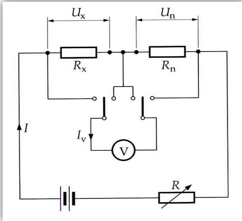
**Slika 6 Usporedbena metoda za mjerjenje malih otpora – serijski spoj, [1], [2], [3], [4], [5], [7], [10].**
