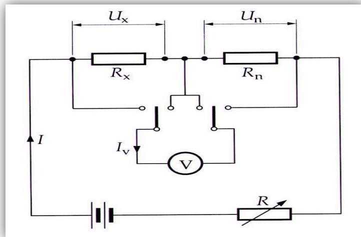
**Slika 14 Usporedbena metoda za mjerjenje malih otpora – serijski spoj, [1], [2], [3], [4], [5], [7], [10].**
