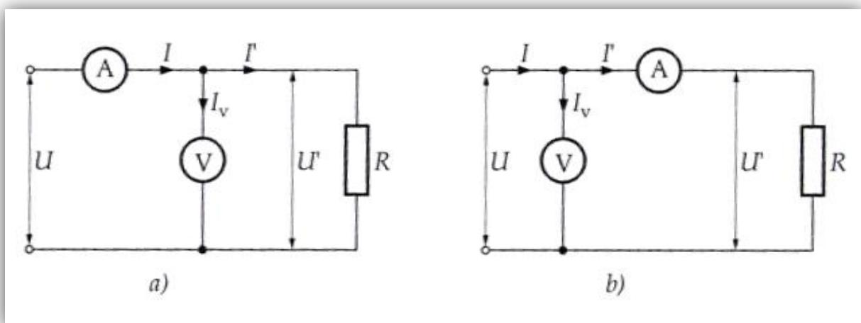
Slika 5 Mjerjenje otpora mjeranjem napona i struje, [1], [2], [7], [10].
