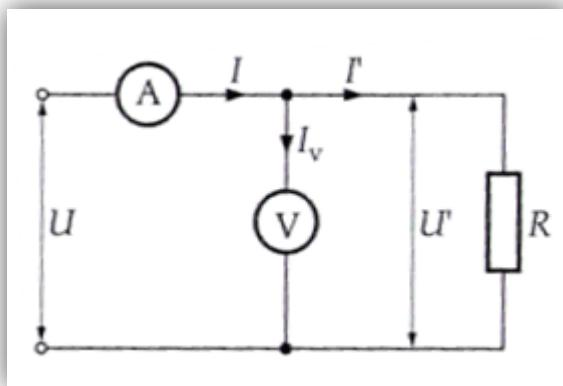
**Slika 13 Mjerenje otpora mjeranjem napona i struje, [1], [2], [7], [10].**
