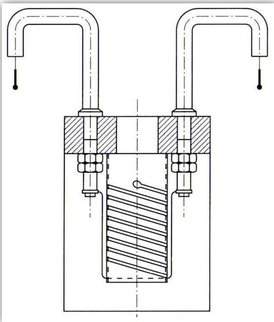
**Slika 1 Etalonski otpornik Njemačkog fizikalno-tehničkog laboratorijsa, [2].**
