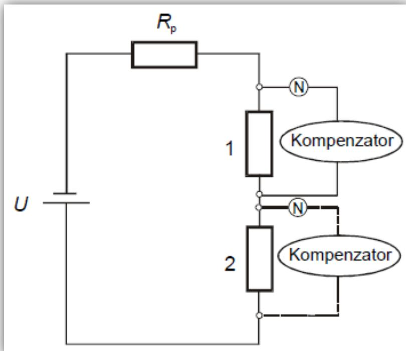
Slika 7 Kompenzacijska metoda mjerjenja otpora, [4], [5], [6].
