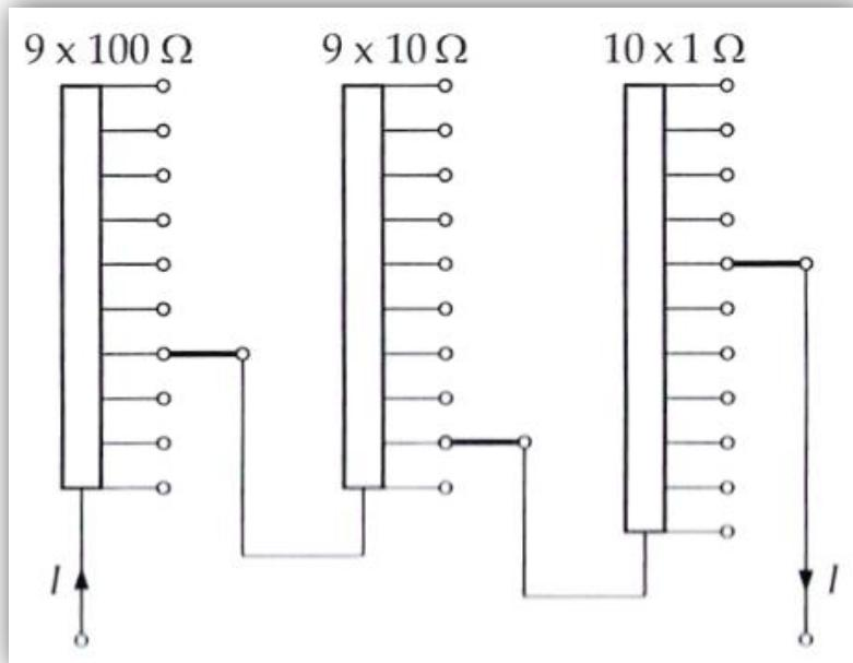
**Slika 3 Skupina preciznih otpornika s preklopkama, [2].**
