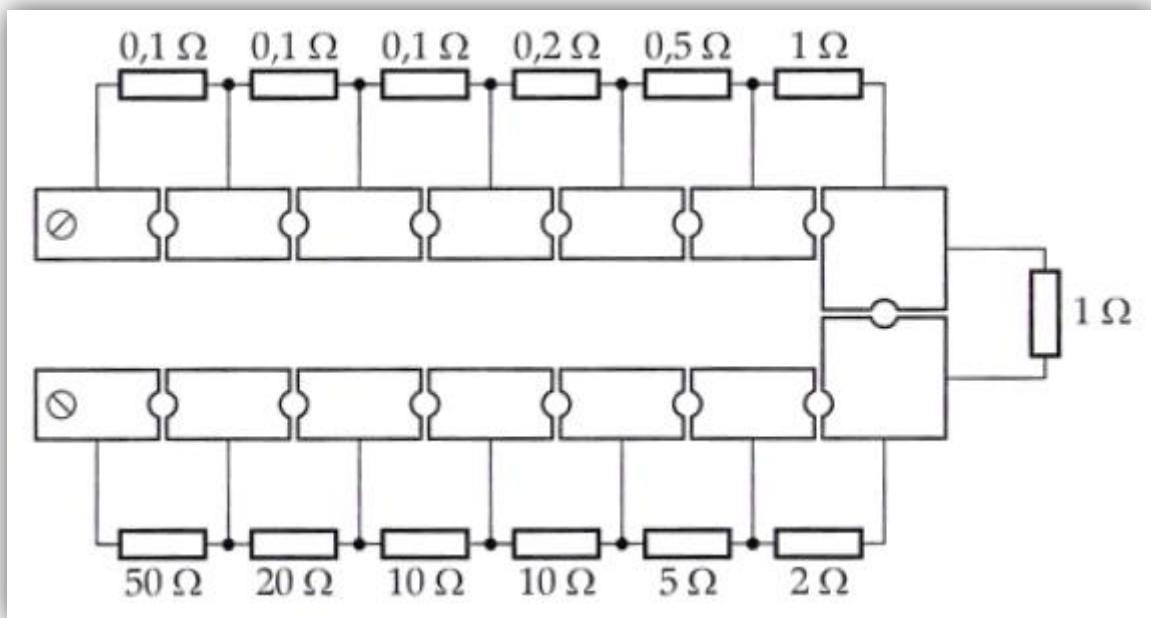
**Slika 2 Skupina preciznih otpornika s čepovima, [2].**
