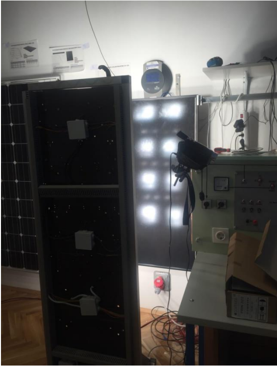
Slike 4.5 i 4.6 prikazuju osvijetljene unutarnje fotonaponske module
