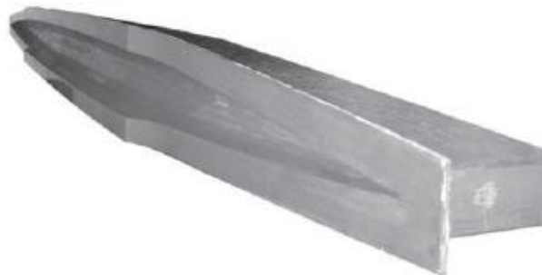
Sl. 3.12. Kalup za vanjsku oplatu uključujući i rub čamca [6]
