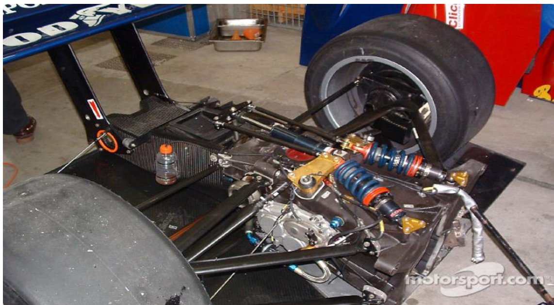
Sl.3.3. Stražnja suspenzija i mjenjač brzina [11]
