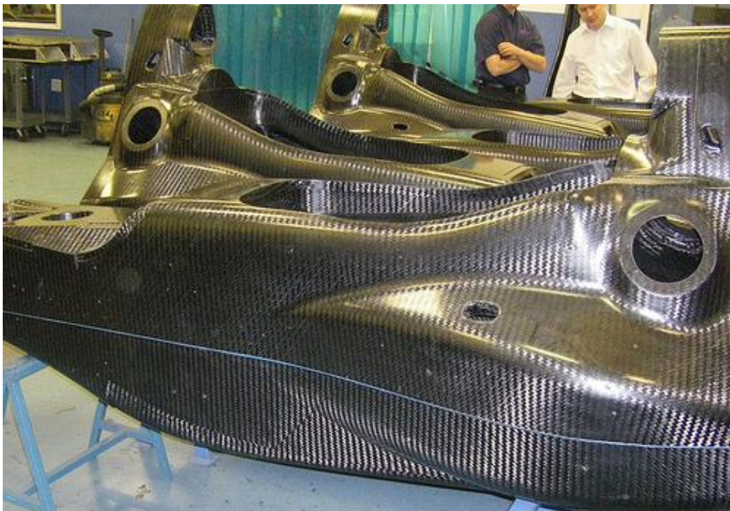
Sl. 3.8. Dio bolida izrađen od "sendvič konstrukcije" kompozitnih materijala
