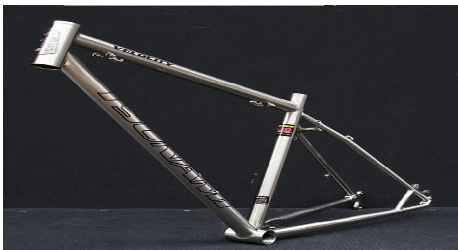
Sl. 3.21. Okvir izrađen od Reynolds 531 poboljšanog čelika [17]
