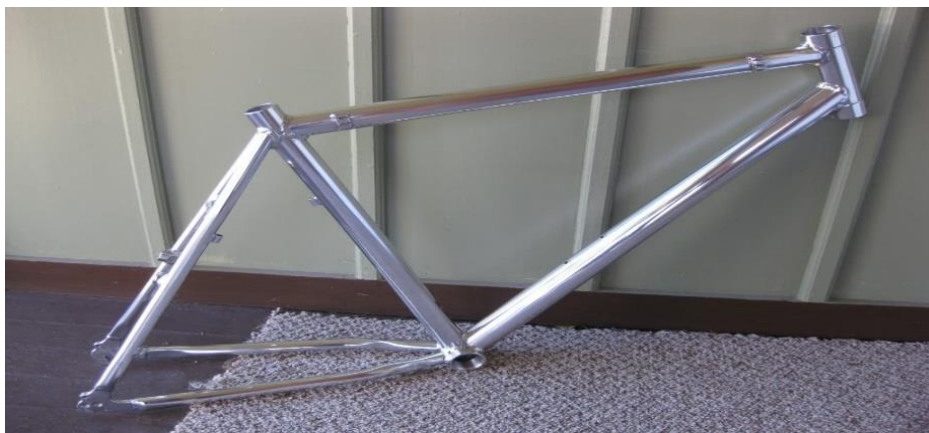
Sl. 3.20. Okvir bicikla izrađen od Al 7075 legure
