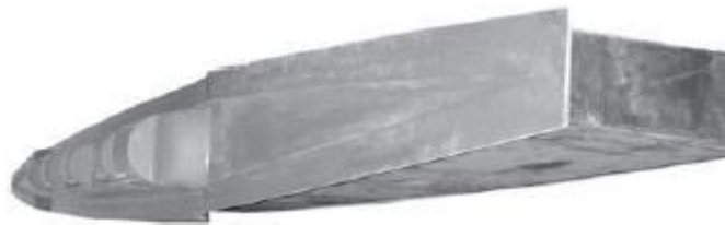
Sl. 3.13. Kalup za unutarnju strukturu [6]
