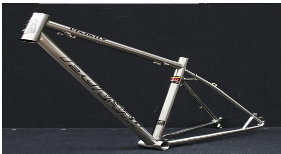
Sl. 3.21. Okvir izrađen od Reynolds 531 poboljšanog čelika [17]
