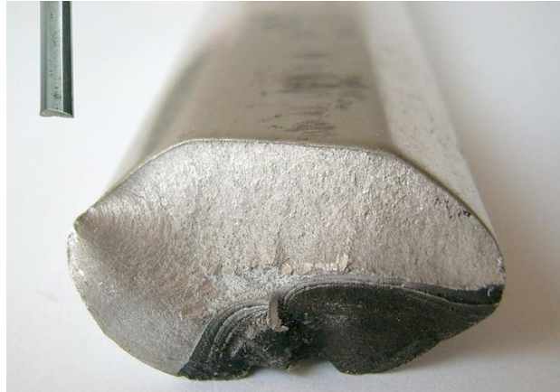
Slika3.2. Lom aluminijske ručice uslijed umora materijala [6]
