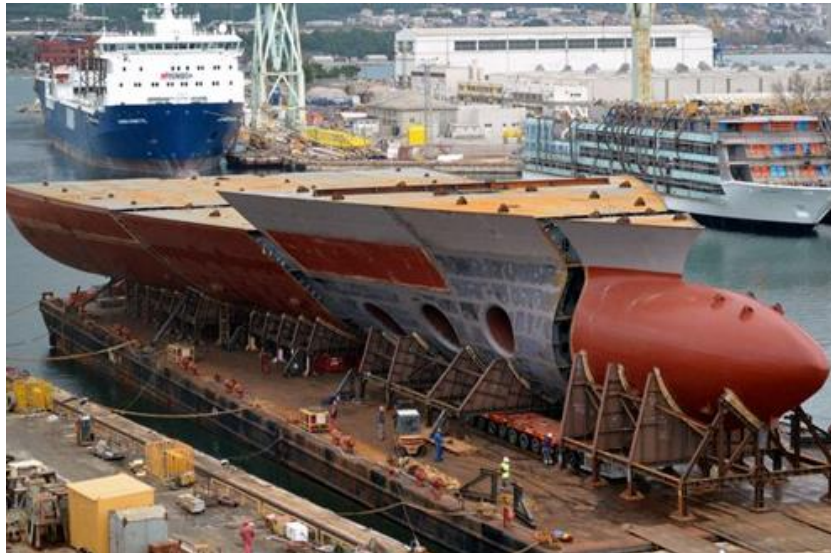
Slika 3.5 Trup broda izrađen od brodograđevinskog čelika [9]
