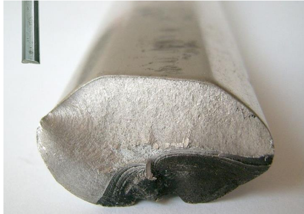
Slika3.2. Lom aluminjske ručice uslijed umora materijala [6]
