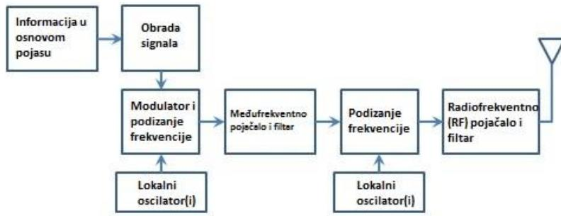
**Slika 2.2.** Blok dijagram komunikacijskog sustava zajedno s modulatorom [2]
