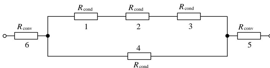
Slika 4.4. Shema toplinskih otpora u kombiniranom spoju
