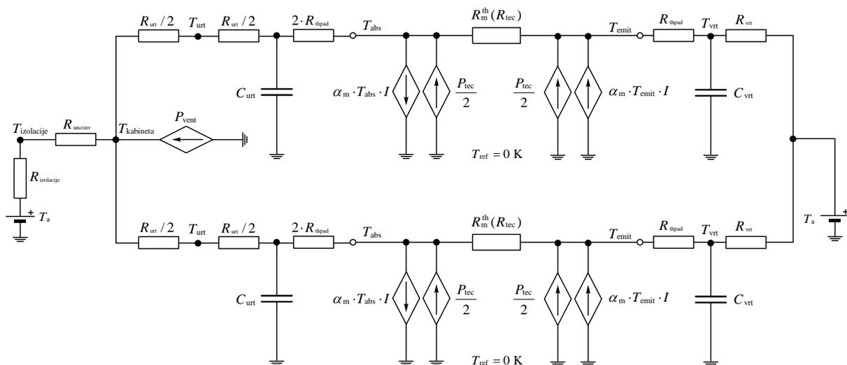
**Slika 8.24.** Minimalno korektna toplinska shema u kojoj je modelirana prijelazna pojava hlađenja (uključeni TEC-ovi).
