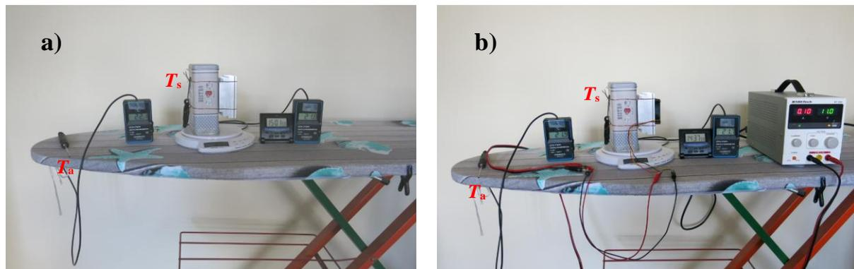
**Slika 8.7.** Uređenje mjernog spoja kojime je mjereno toplinski otpor rebrastog rashladnog tijela
