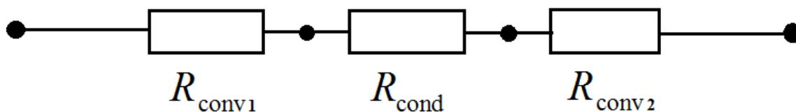
**Slika 4.1.** Prikaz toplinskih otpora u serijskom spoju
