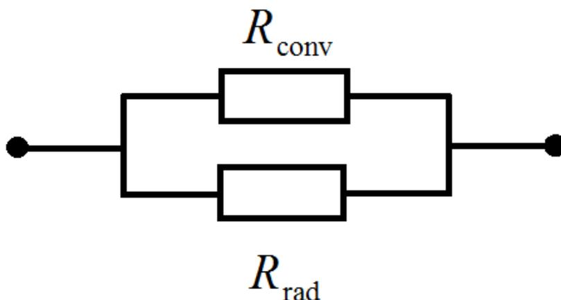
**Slika 4.2.** Prikaz toplinskih otpora u paralelnom spoju
