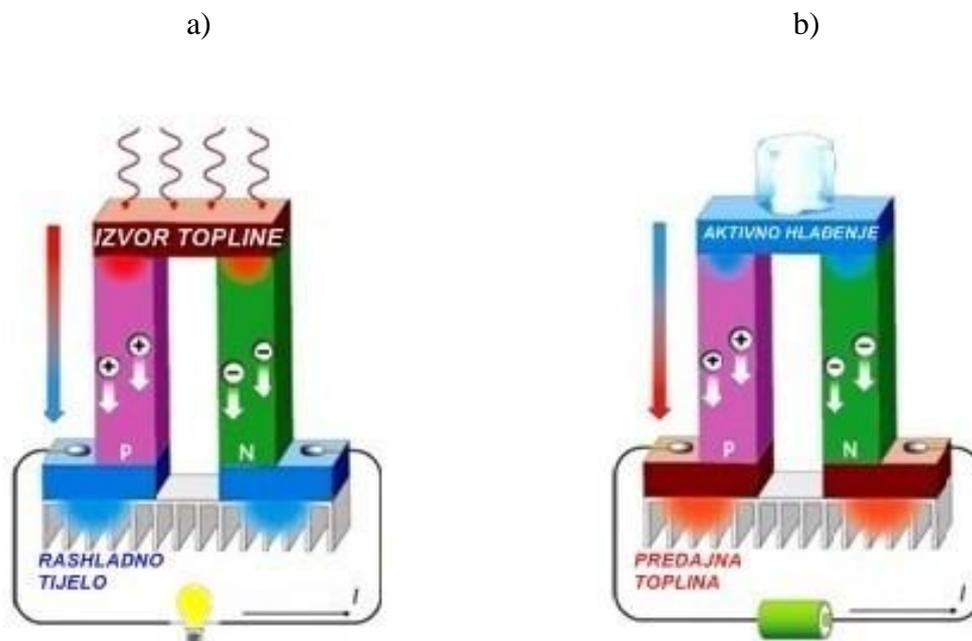
**Slika 4.1.** a) Princip rada termogeneratora; b) Princip rada termoelektričnog hladila
