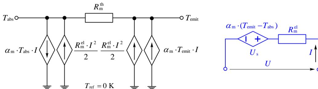
**Slika 6.7.** Ekvivalentna shema TEC-a. Toplinski kapaciteti apsorbirajuće i emitirajuće strane su zanemareni. Toplinski otpor TEC-a je modeliran koncentriranim parametrom. Polovina električnih gubitaka postavljena je na apsorpcijsku stranu, a druga polovina na emitirajuću.
