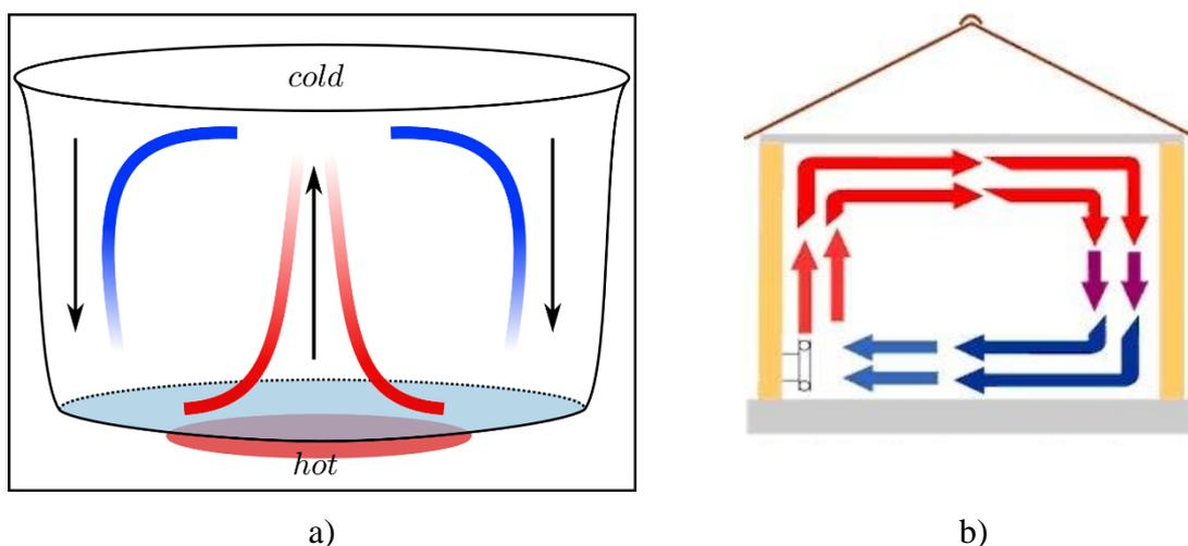
**Slika 3.3.** a) Strujanje vode u loncu; b) Strujanje zraka u prostoriji
