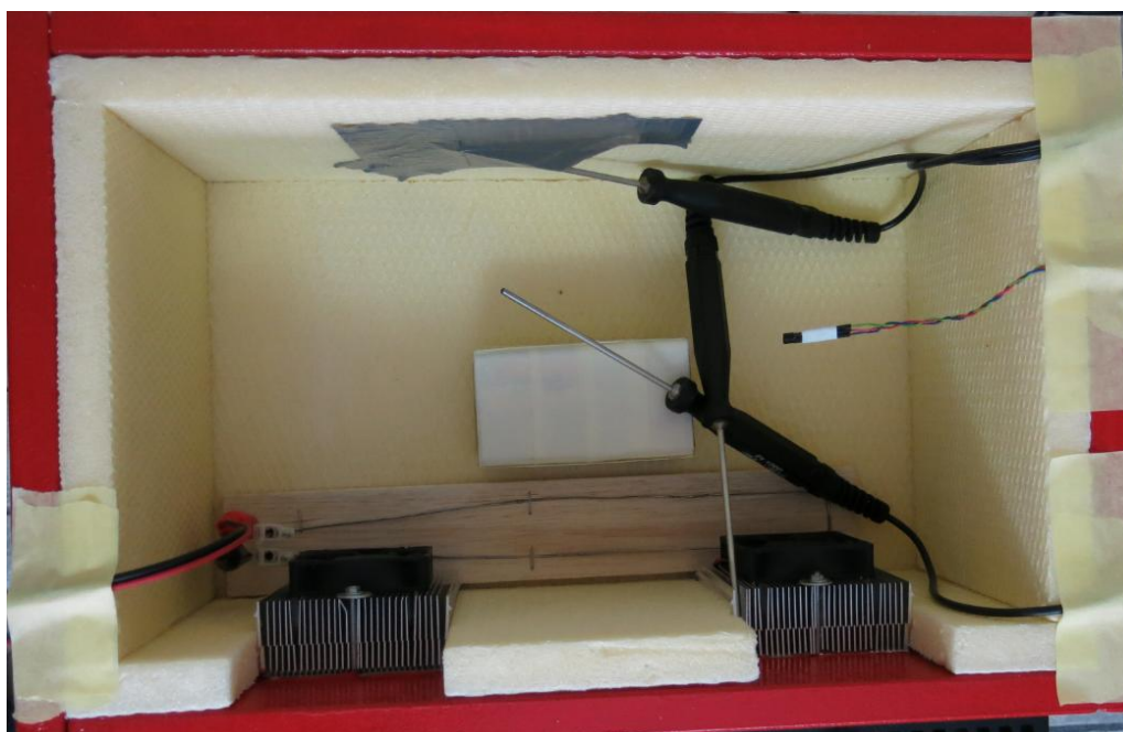
Slika 8.13. Uvećan detalj na položaj mjernih sondi unutar kabineta hladnjaka
