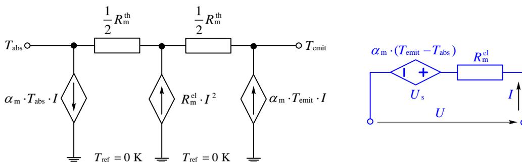
**Slika 6.8.** Ekvivalentna shema TEC-a. Toplinski kapaciteti apsorbirajuće i emitirajuće strane su zanemareni. Toplinski otpor TEC-a je modeliran kao distribuirani parametar. Električni gubitci modelirani su kao koncentriran parametar.
