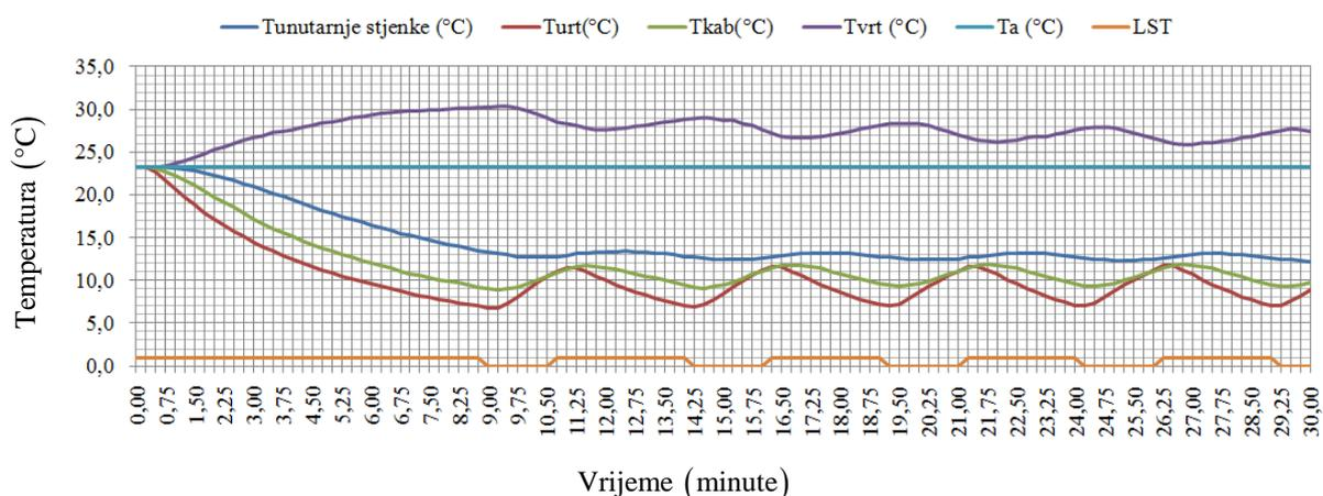
**Slika 8.28.** Logičko stanje termostata (LST) te izmjerene temperature tijekom procesa hlađenja/grijanja kada je uključen termostat, a temperatura termostata podešena na  $10\text{ }^{\circ}\text{C}$
