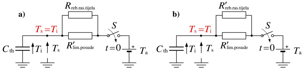
**Slika 8.8.** Uređenje mjernog spoja kojime je mjereno toplinski otpor rebrastog rashladnog tijela
