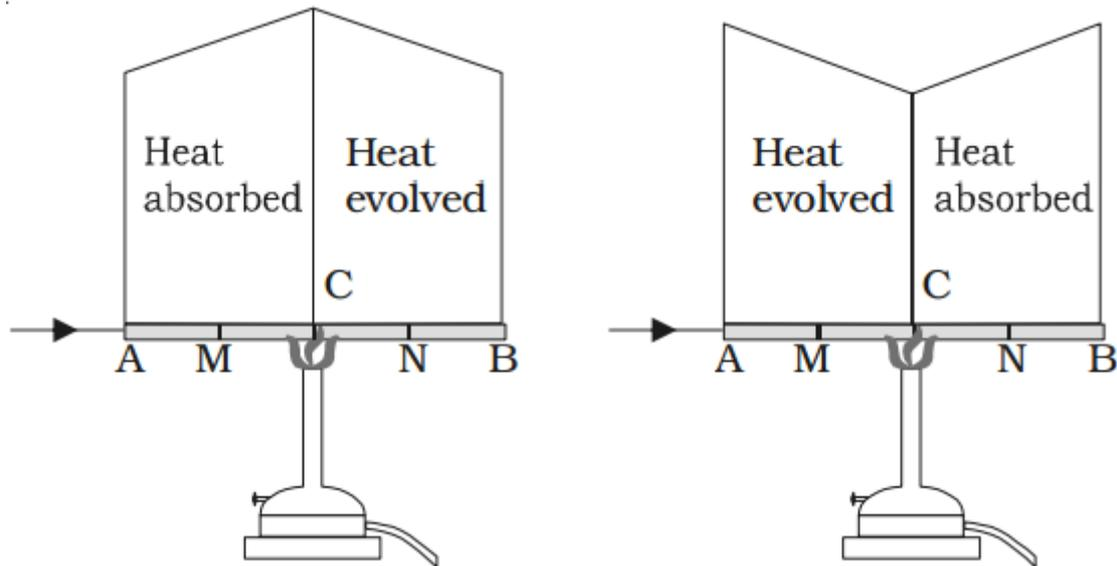
**Slika 5.6.** Ovisnost Thomsonovog efekta o smjeru struje
