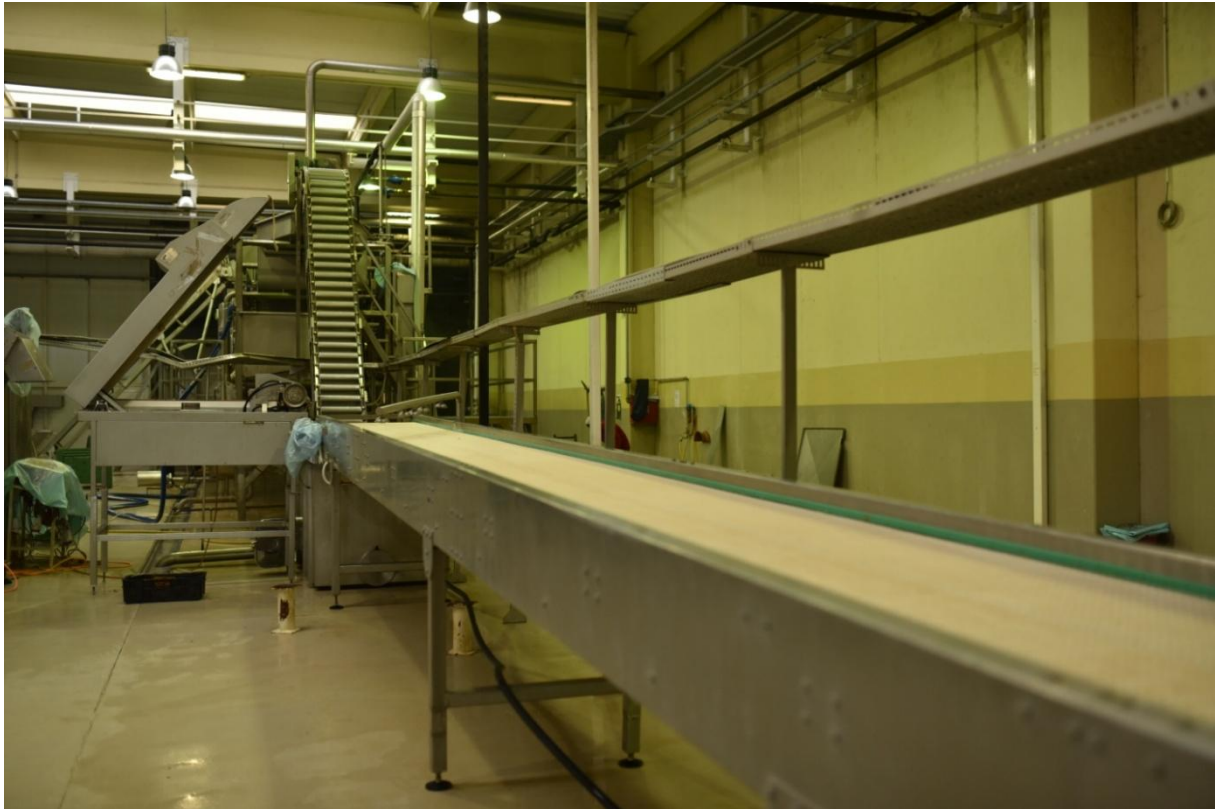
Slika 3.16. Vibrirajući transporter – dozator [1]
