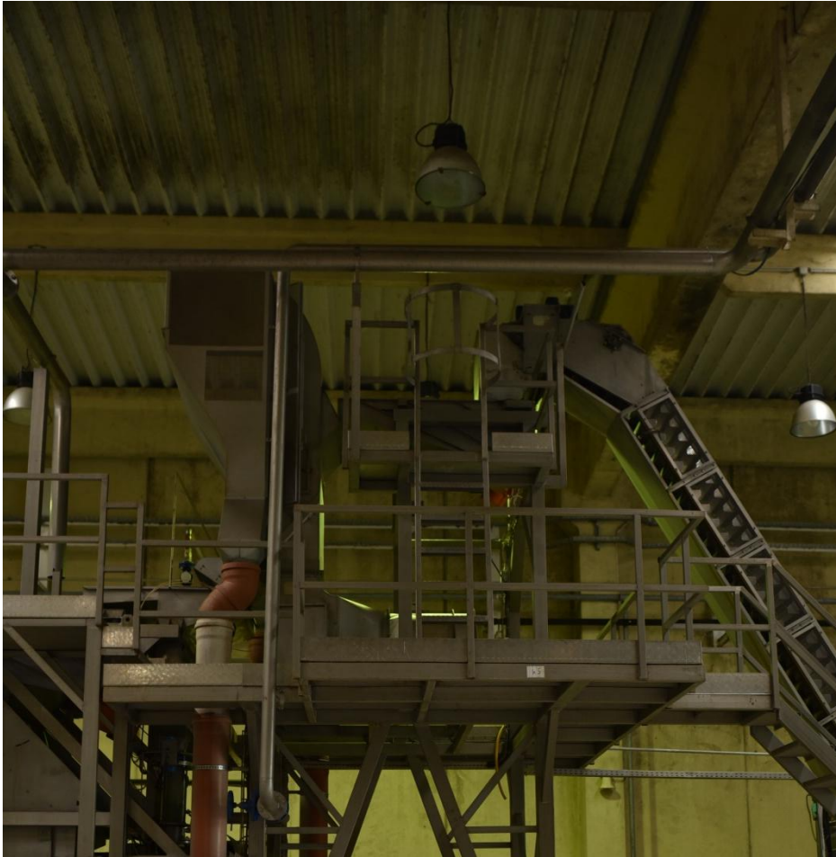
Slika 3.9. Spajanje zračnog separatora i transportera sa strugačima [1]
