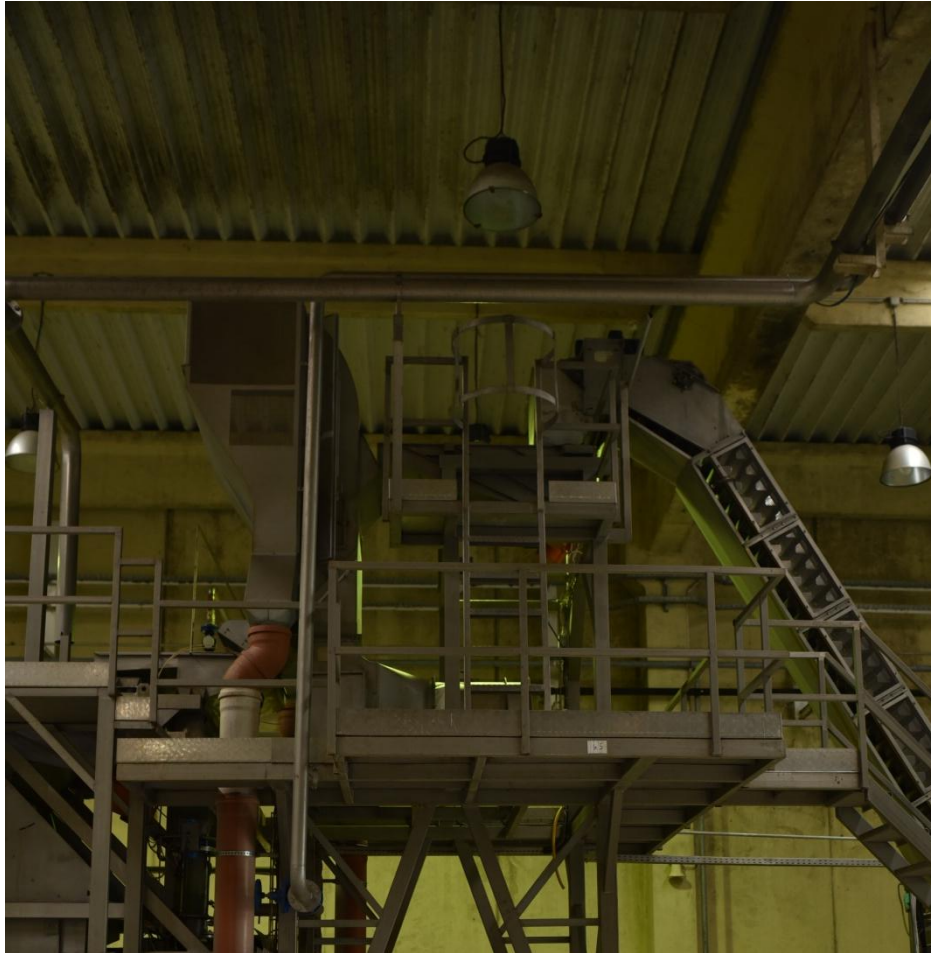
Slika 3.9. Spajanje zračnog separatora i transportera sa strugačima [1]
