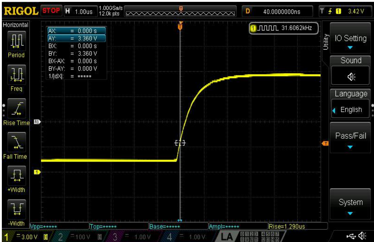
Slika 3.2.2-Punjenja kondenzatora kapaciteta 56pF( X os- 1.00 \mu s/div, Y os- 3V/div)
