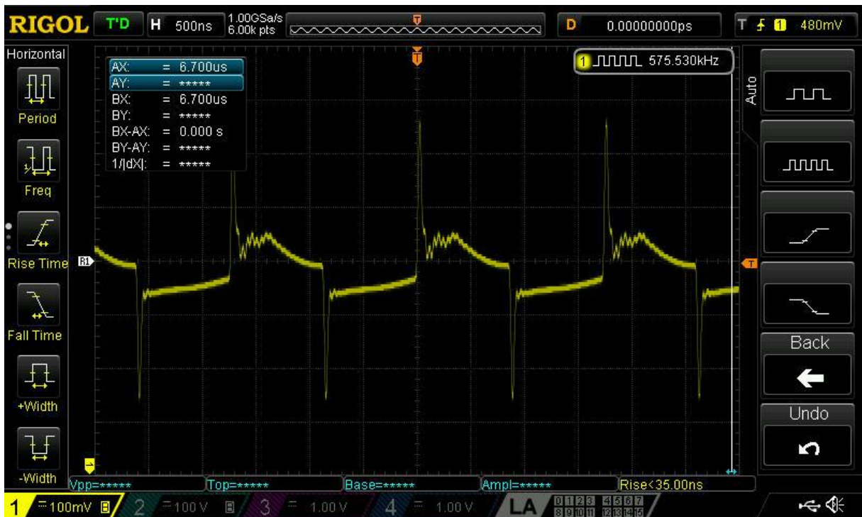
3.1.11 Izgled signala (pravokutnog) na izlazu iz derivatora mjernog kapaciteta 68pF ( f=575,5\text{kHz} )
