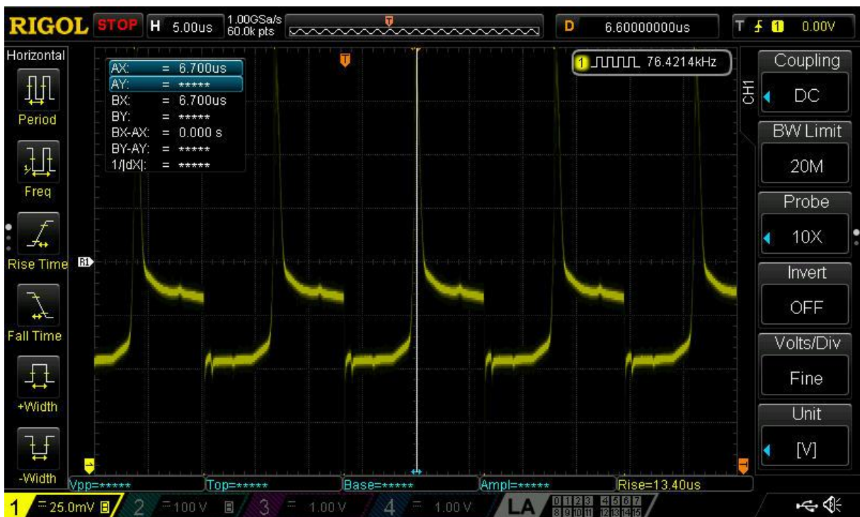
3.1.10 Izgled signala (pravokutnog) na izlazu iz derivatora mjernog kapaciteta 68pF ( f=76,42 kHz)
