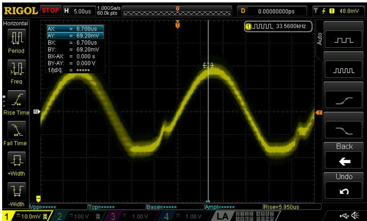
3.1.16 Izgled signala (sinusnog) na izlazu iz derivatora mjernog kapaciteta 68pF ( f=33,56\text{kHz} )
