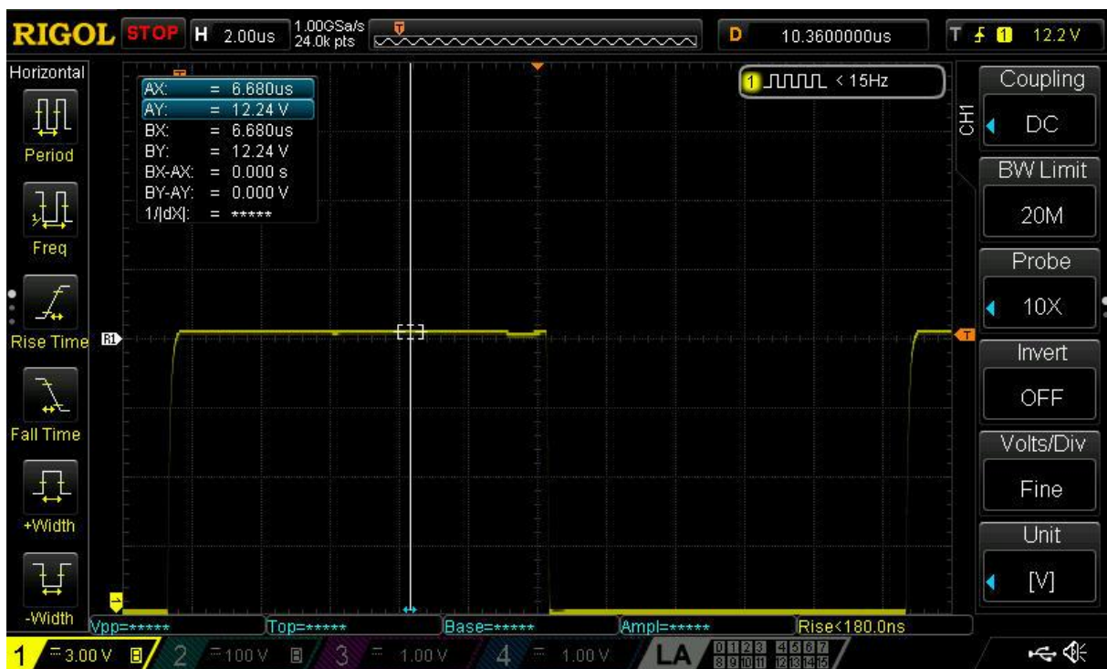
Slika 3.2.7-Signal poslije komparatora za 470pF
