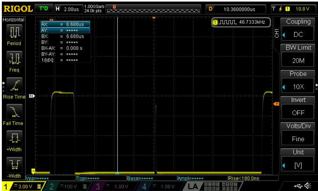
Slika 3.2.5-Signal poslije komparatora za 56pF(X os-2.00 \mu s, Y os-3V/div)
