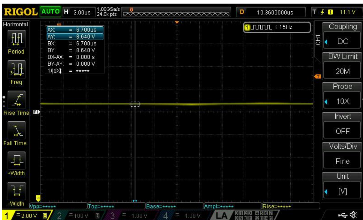
Slika 3.2.13-Konstantni napon nakon induktivneta za 470pF
