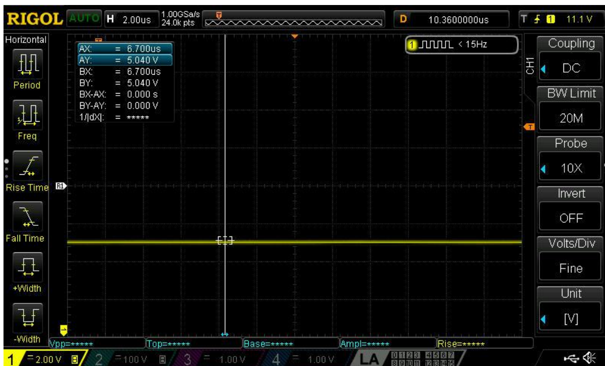
Slika 3.2.12-Konstantni napon nakon induktivneta za 220pF
