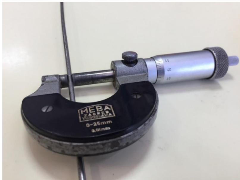
**Slika 2.6.** Mjerenje promjera žice mikrometarskim vijkom
