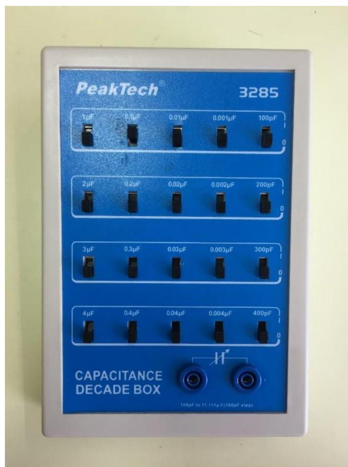
Slika 2.9. Blok kondenzator
