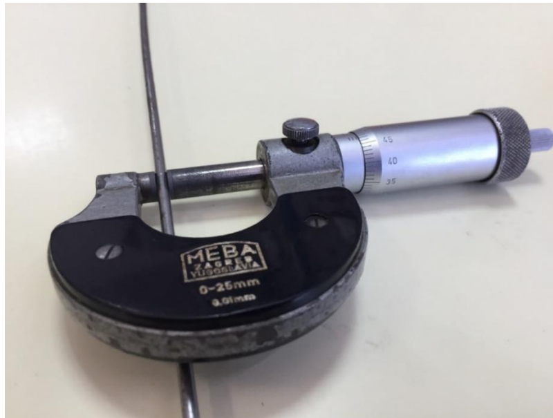
Slika 2.6. Mjerenje promjera žice mikrometarskim vijkom
