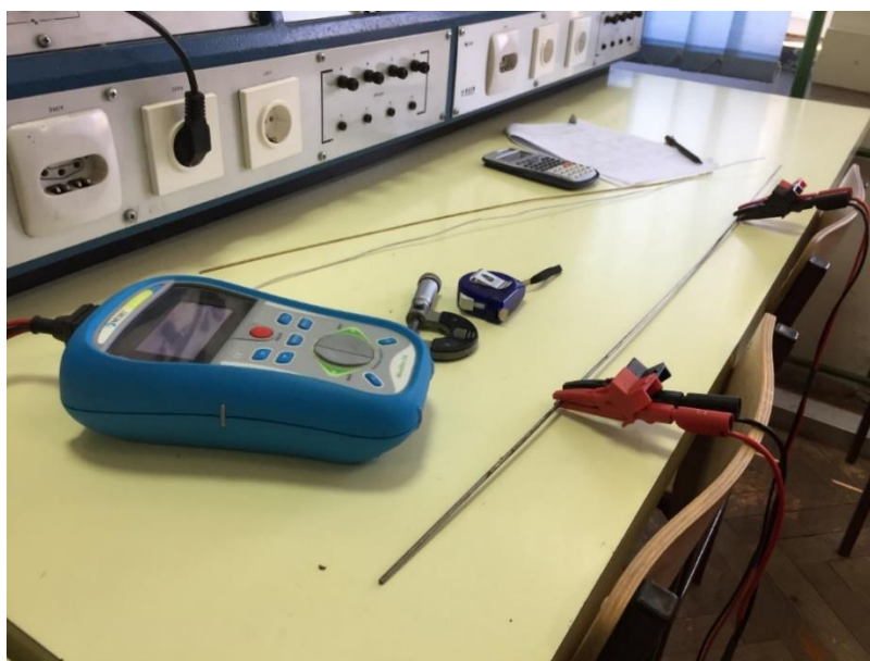
Slika 2.7. Spajanje stezaljki Thomsonovog mosta te mjerenje otpora
