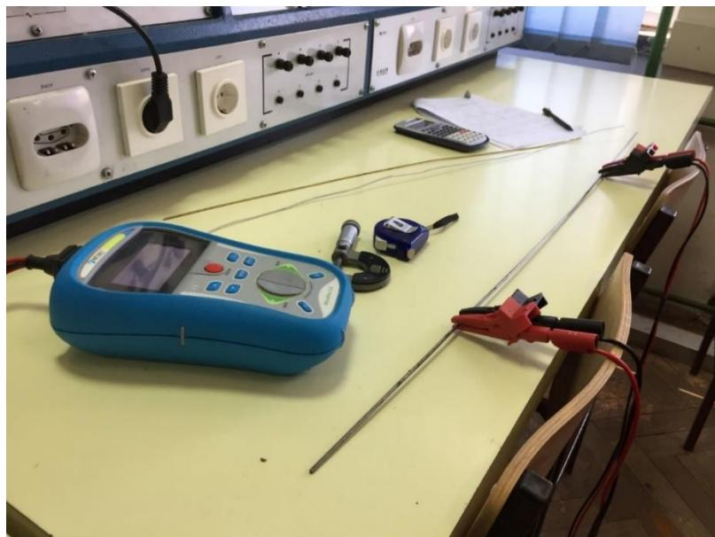
**Slika 2.7.** Spajanje stezaljki Thomsonovog mosta te mjerenje otpora
