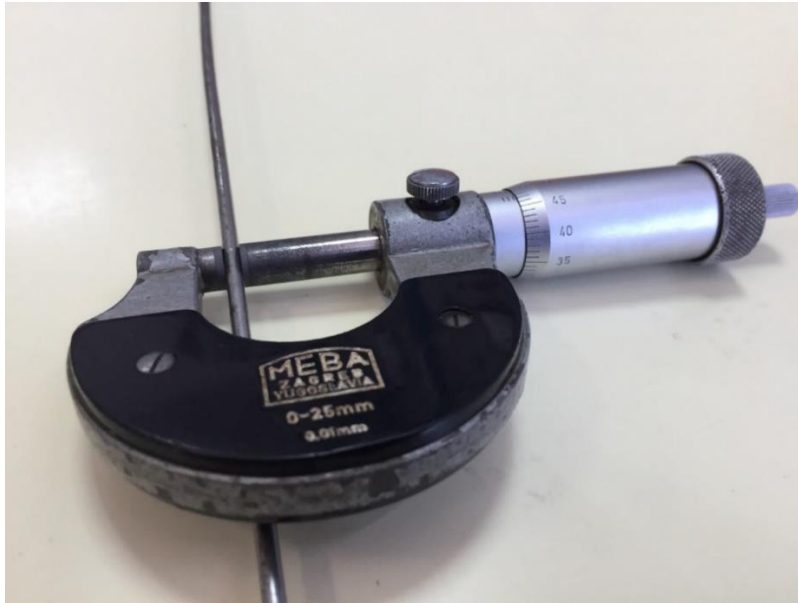
Slika 2.6. Mjerenje promjera žice mikrometarskim vijkom
