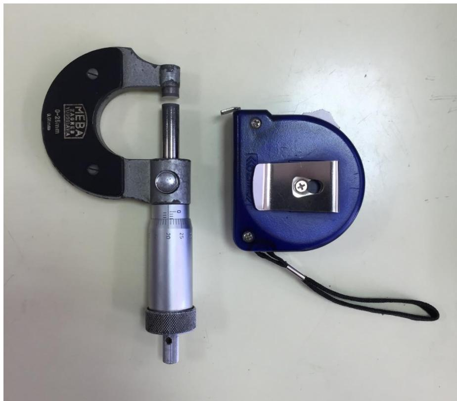
Slika 2.4. Mikrometarski vijak i mjerna traka
