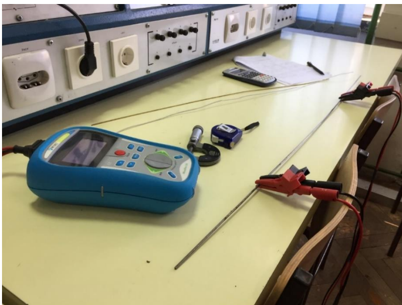
Slika 2.7. Spajanje stezaljki Thomsonovog mosta te mjerenje otpora
