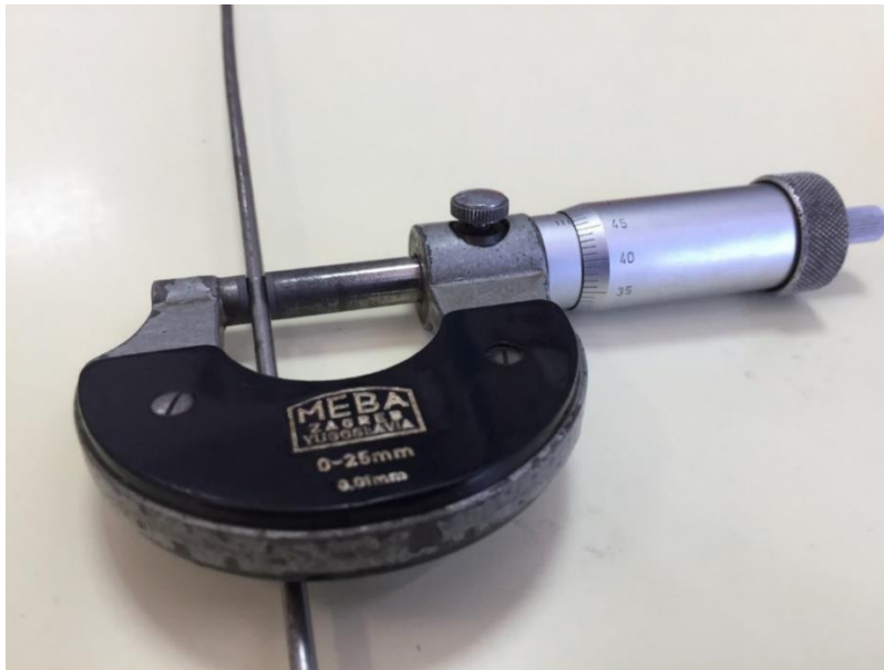
Slika 2.6. Mjerenje promjera žice mikrometarskim vijkom
