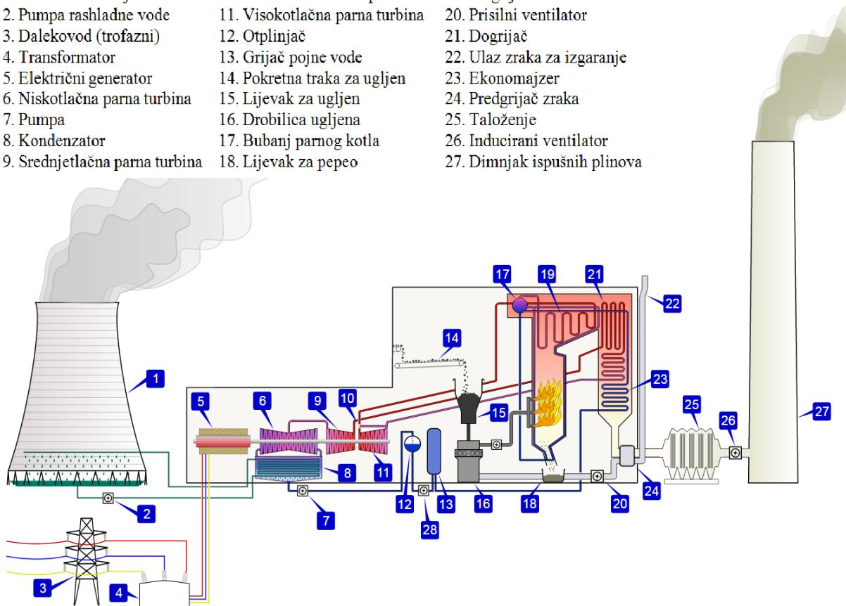
Slika 2.1. Osnovni prikaz termoelektrane [2]
