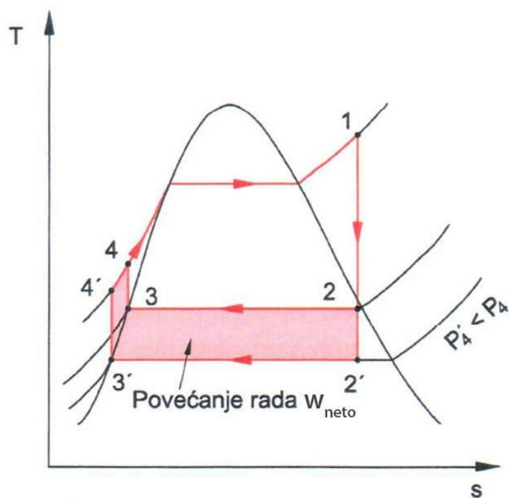
Slika 2.12. Smanjenje tlaka u kondenzatoru (T-s dijagram) [10]
