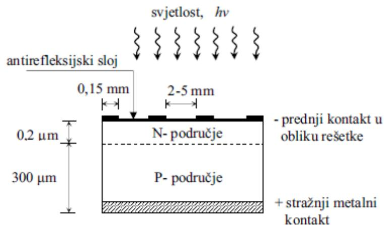
**Slika 2.7. Fotonaponski efekt [5]**
