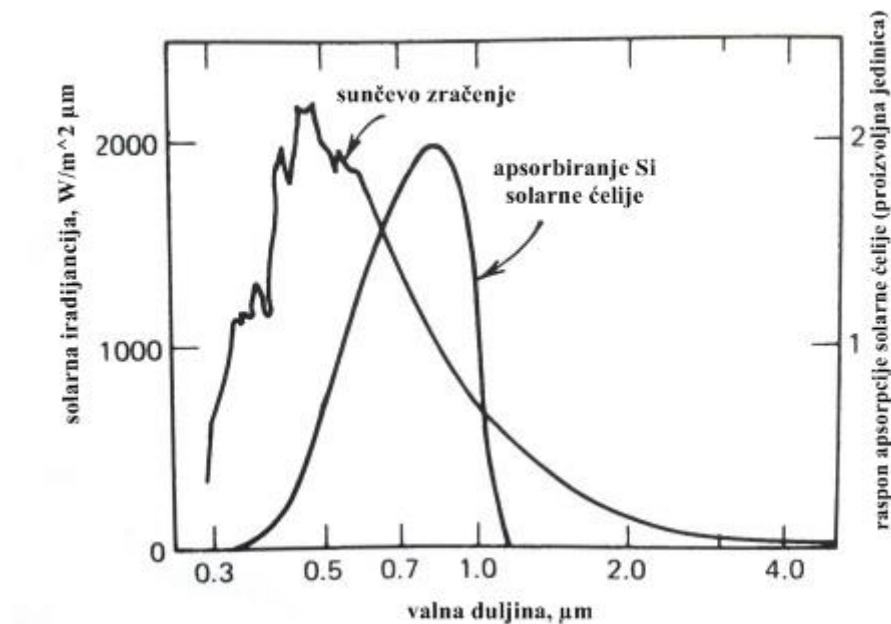
Slika 3.1. Solarno zračenje i valne duljine koje čelija apsorbira [7]
