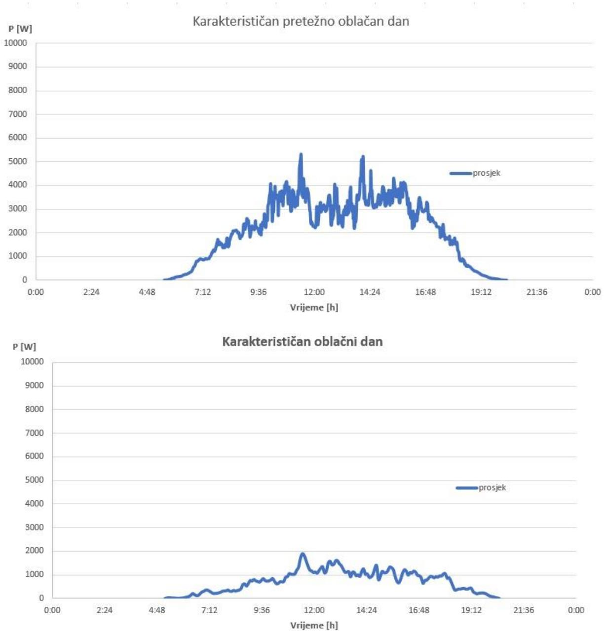
**Slika 3.10.** Niska proizvodnja električne energije
