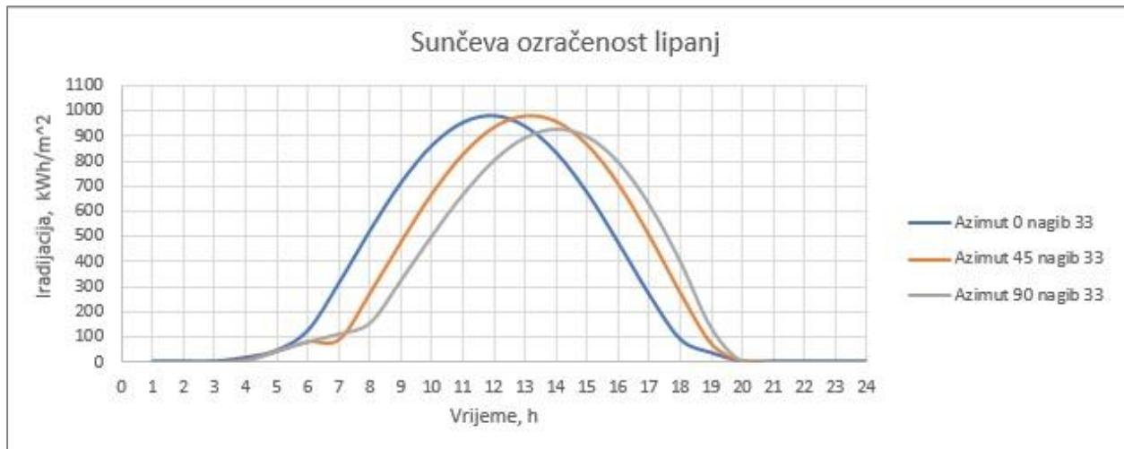
Slika 4.24. Prikaz ozračenosti površina modula zakretanjem prema zapadu.
