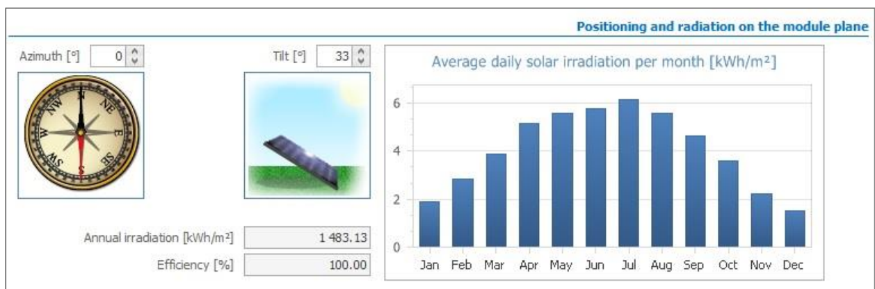
Slika 4.6. Optimalni kut za lokaciju grada Osijeka
