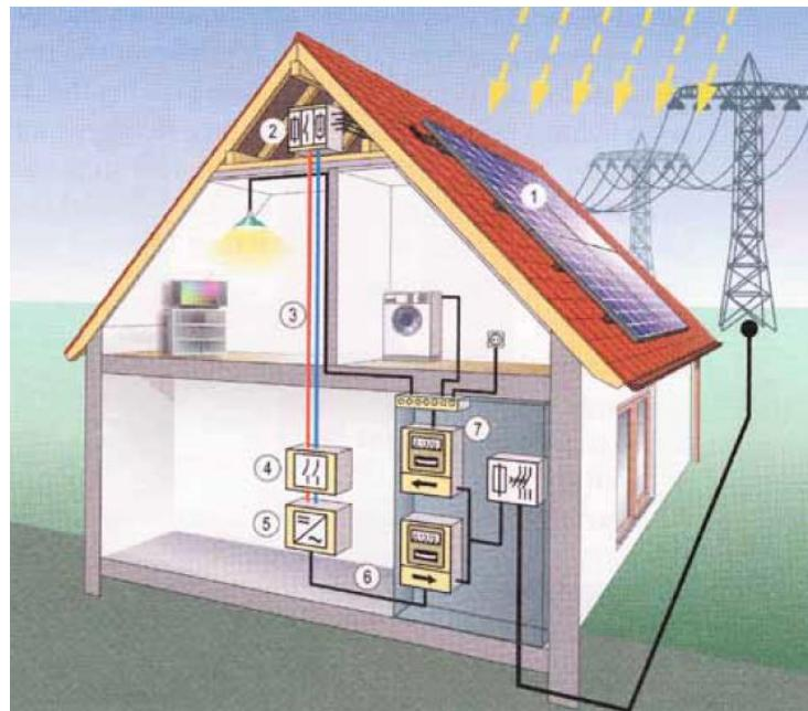
**Slika 2.12.** Fotonaponski sustav priključen na mrežu preko kućne instalacije [4].
