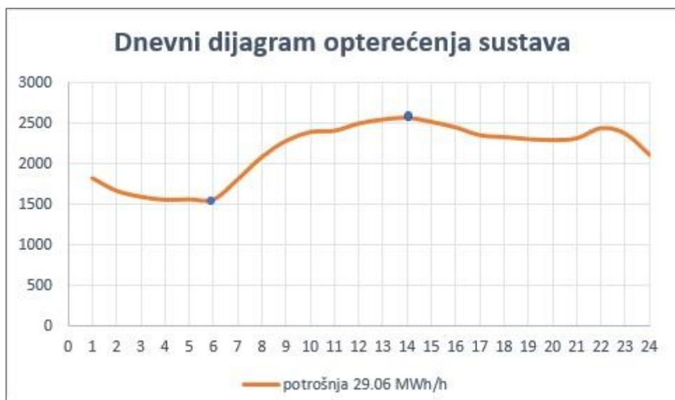
Slika 4.21. Dnevni dijagram opterećenja elektroenergetskog sustava 29. lipnja 2017. g.
