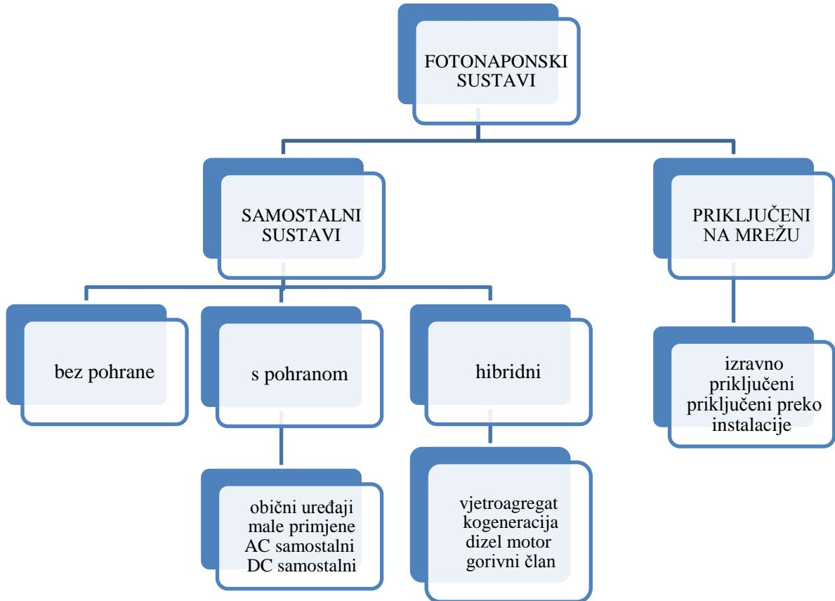
**Slika 2.11.** Osnovna podjela fotonaponskih sustava
