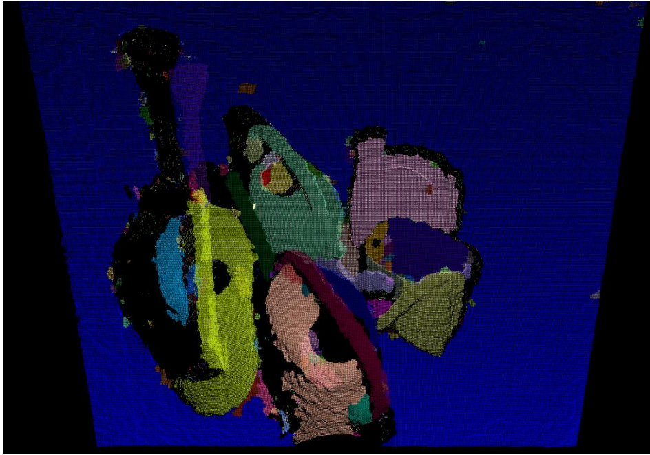
Sl.5.58. Slika segmentirana metodom lokalno konveksnih povezanih segmenata
