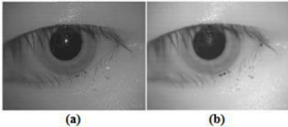
Slika 3.3: Prikaz šarenice prije (a) i nakon primjene median filtera(b). [15]
