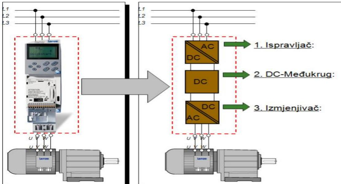
Slika 3.1. Frekventni pretvarač
