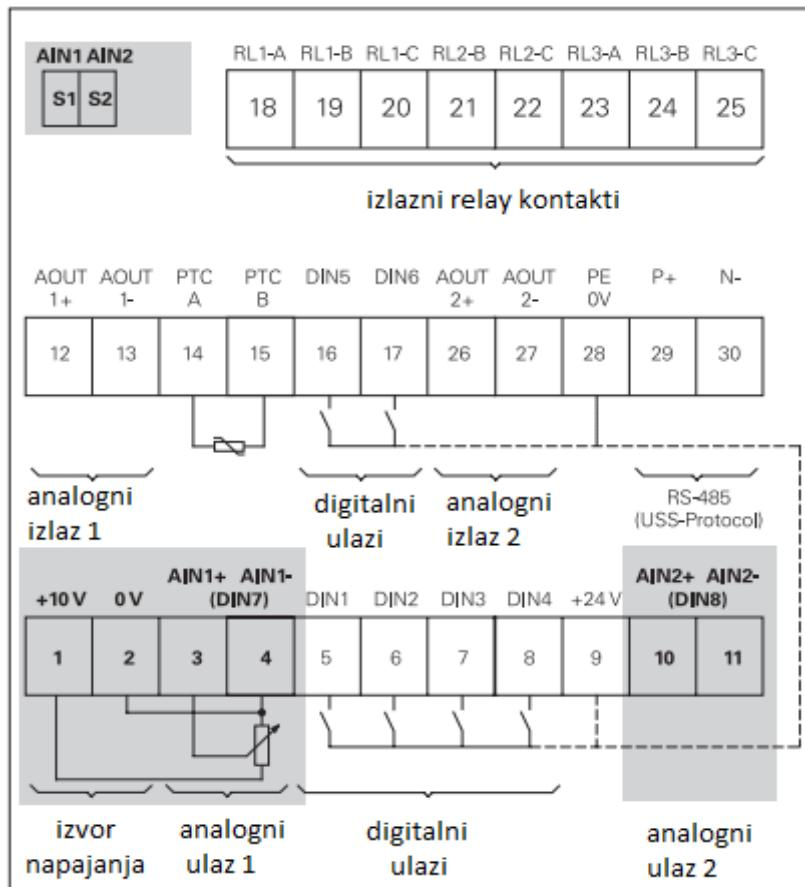
Slika 5.6. spajanje analogni ulaza Micromastera
