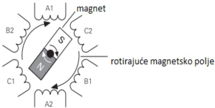
Slika 2.6. Reakcija magneta s rotirajućim magnetskim poljem statora
