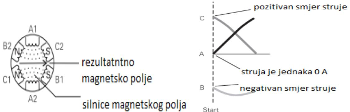
Slika 2.2. Rezultantno magnetsko polje statora
