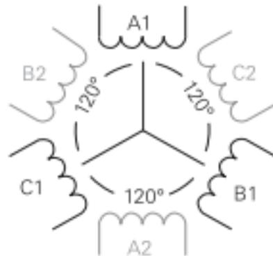
Slika 2.1. Dvopolni namot statora
