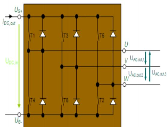
Slika 3.8. Izmjenjivač s ekvivalentnim sklopkama
