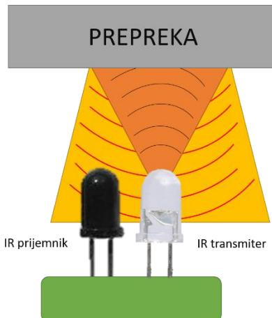
Slika 4.3. Način rada IR senzora za prepreke
