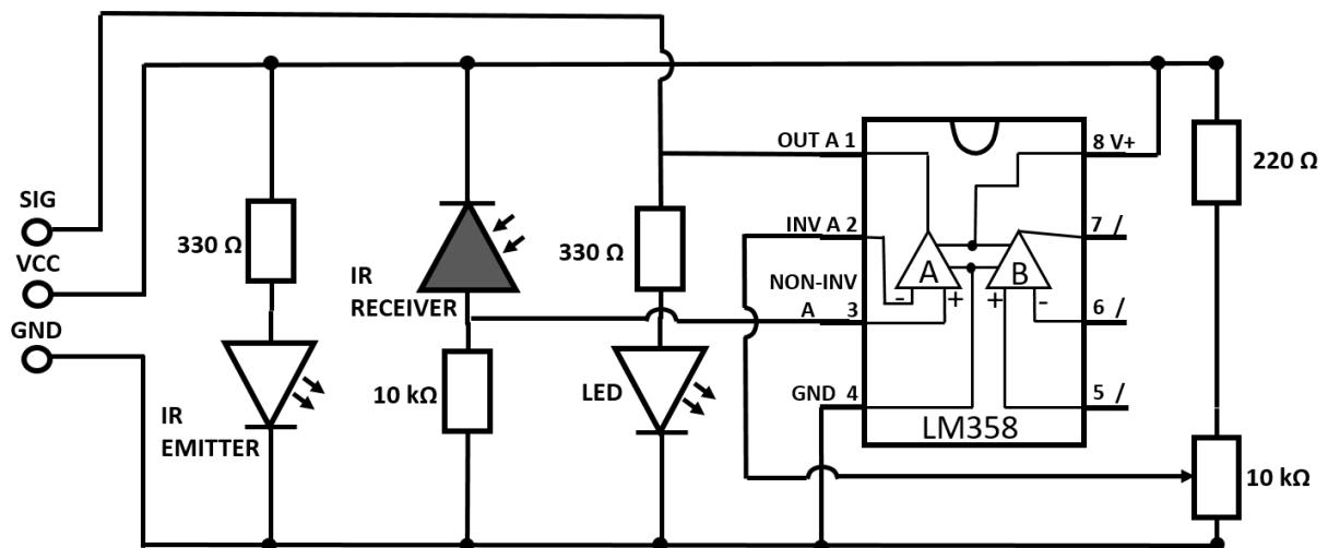
Slika 4.2. Shema izrađenih senzora za detekciju prepreke
