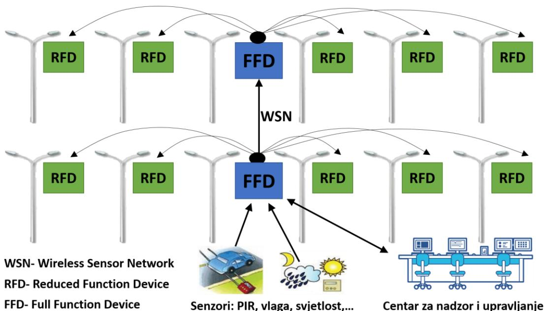
Slika 3.4. Struktura sustava za upravljanje javnom rasvjjetom uz korištenje ZigBee protokola [26]
