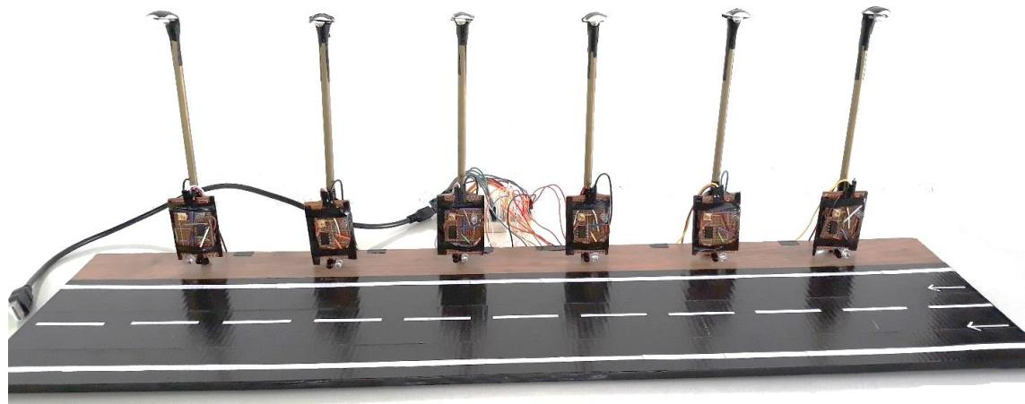
Slika 4.8. Maketa pametne cestovne rasvjete korištenjem IR senzora
