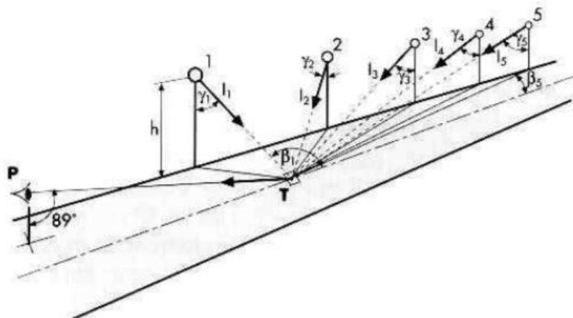
Slika 2.2. Ukupna luminacija točke površine kolnika [4]
