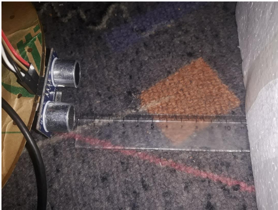
Slika 36. HCSR-04 senzor na udaljenosti od 11cm
