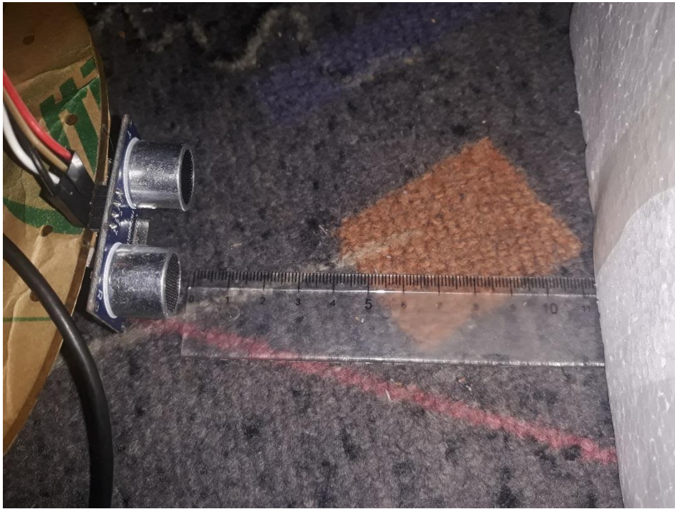
Slika 36. HCSR-04 senzor na udaljenosti od 11cm
