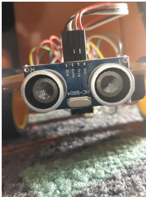
Slika 15. HC-SR04 senzor na robotskim kolicima
