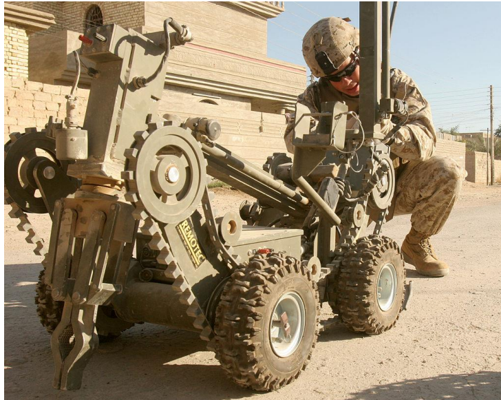
Slika 1. Telemanipulator za istraživanje potencijalno eksplozivnih uređaja
