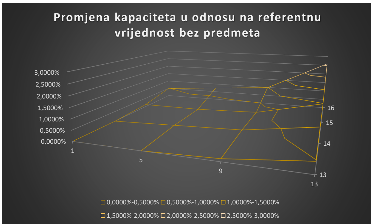
Sl. 4.7. Površinski grafikon koji prikazuje promjenu kapaciteta u odnosu na referentnu vrijednost bez predmeta, trodimenzionalni prikaz.
