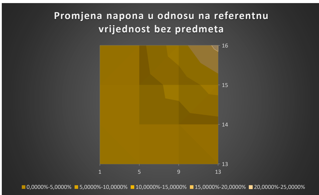
Sl. 4.15. Površinski grafikoni koji prikazuju promjenu napona u odnosu na referentnu vrijednost bez predmeta, dvodimenzionalni prikaz.
