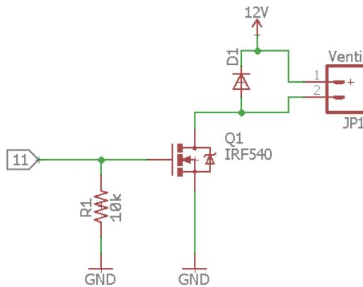
Sl. 3.3.: Dioda za zaštitu od inducirane struje
