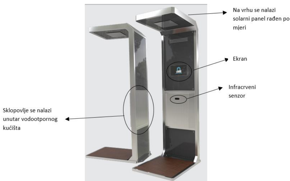
Sl. 2.1.: Vodeni tuš na solarnu energiju UNNI. 1
