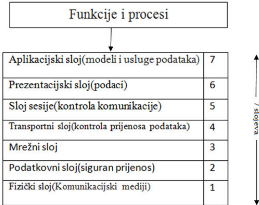
Slika 4.2. ISO / OSI komunikacijski referentni model [34]
