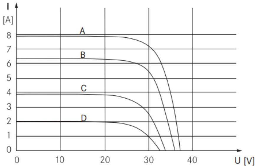
A: 1000 W/m<sup>2</sup> | B: 800 W/m<sup>2</sup> | C: 500 W/m<sup>2</sup> | D: 250 W/m<sup>2</sup>
