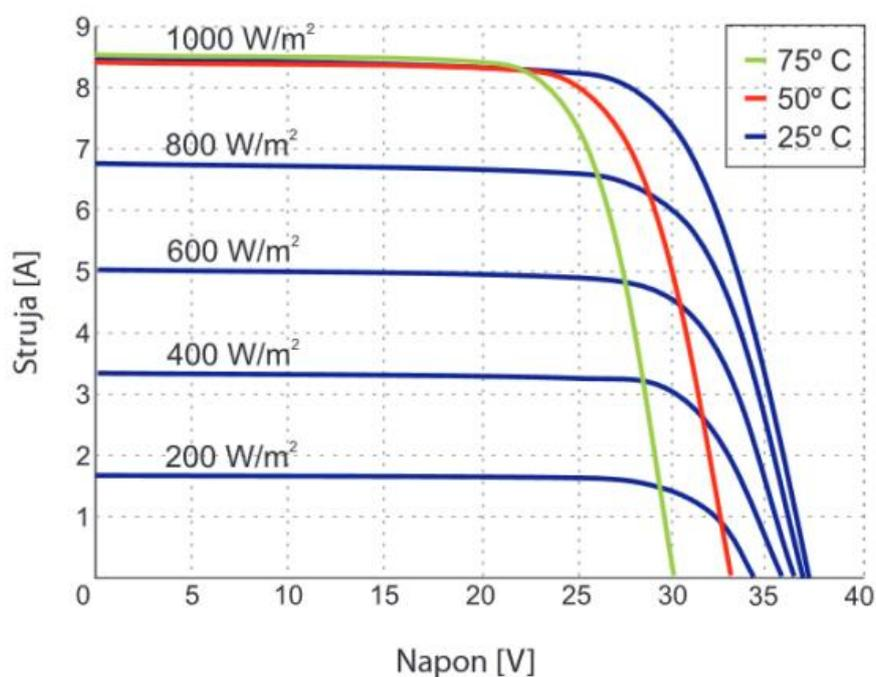
**Slika 3.2.** Strujno – naponske karakteristike modula Bisol BMU 250 [6]
