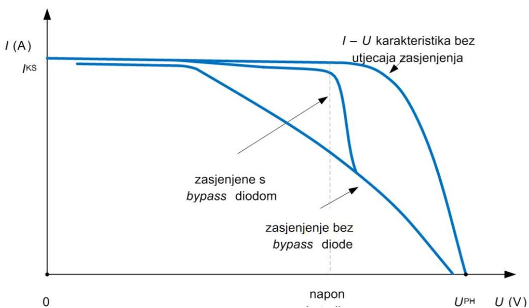
Slika 2.10. Utjecaj prenosne diode na I-U karakteristiku [2]
