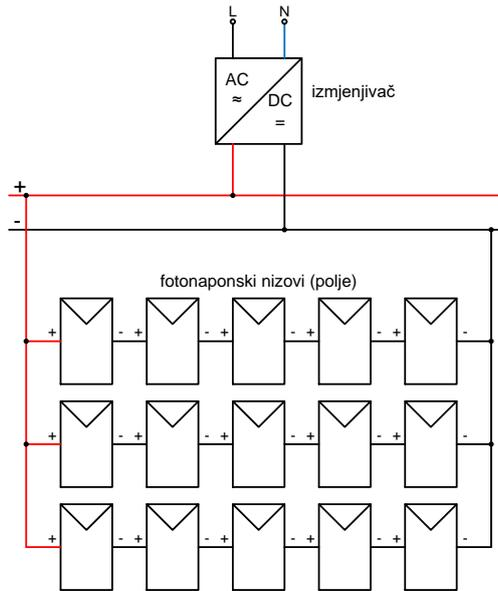
**Slika 2.11.** Mrežna fotonaponska elektrana s jednim izmjenjivačem [2]
