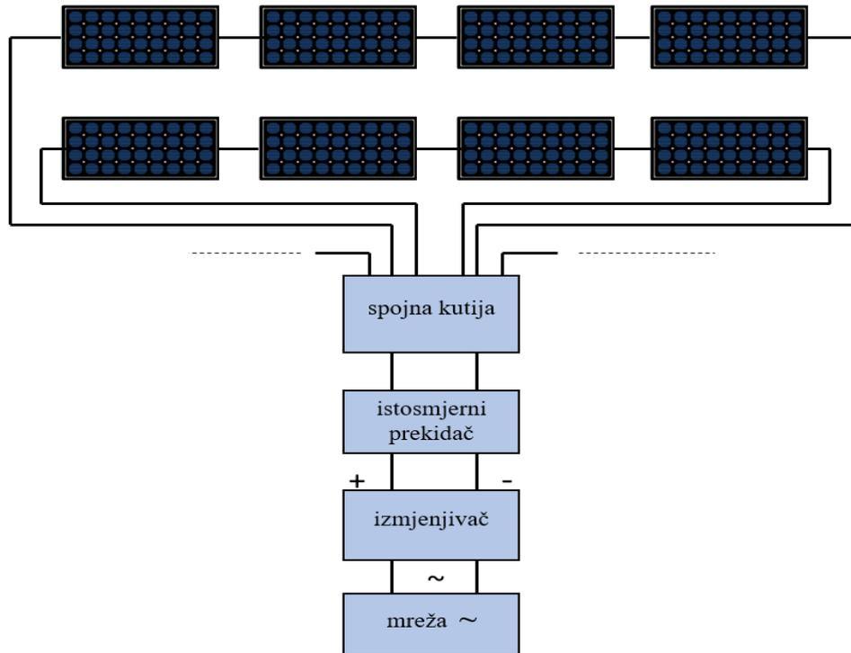
**Slika 2.11.** Fotonaponski sustav s centralnim izmjenjivačem i transformatorom [3]
