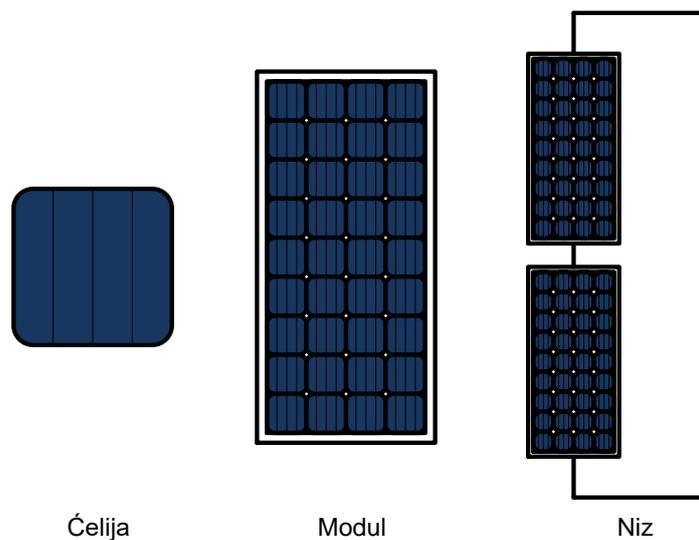
**Slika 2.7.** Fotonaponska ćelija, modul i niz [2]
