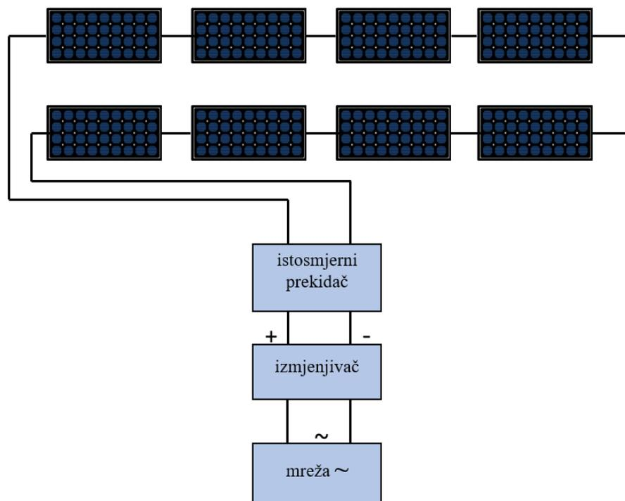
*Slika 2.12. Fotonaponski sustav s centralnim izmjenjivačem bez transformatora [3]*
