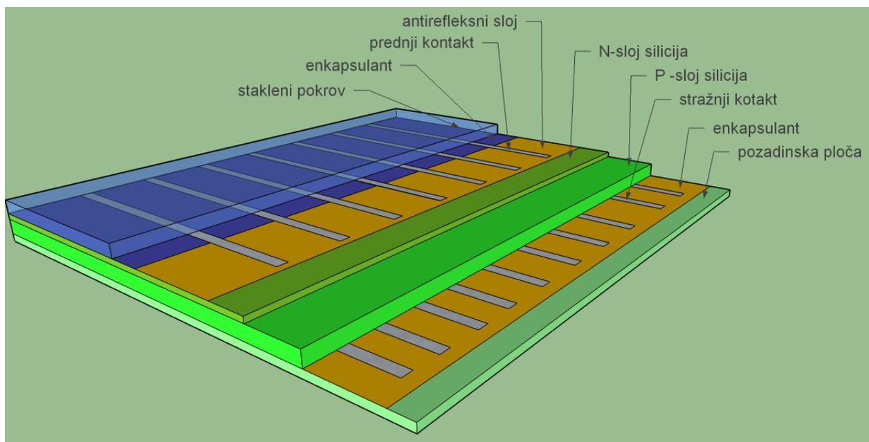
*Slika 2.3. Fotonaponska ćelija [2]*
