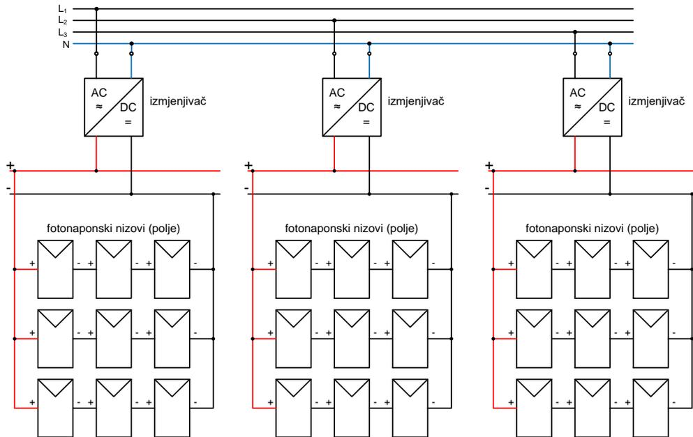
*Slika 2.13. Mrežna fotonaponska elektrana s više izmjenjivača [2]*
