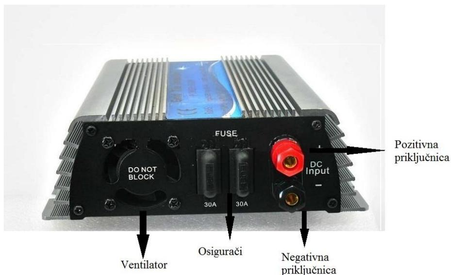
*Slika 3.5. Dijelovi mikro invertera, stražnja, priključna strana*
