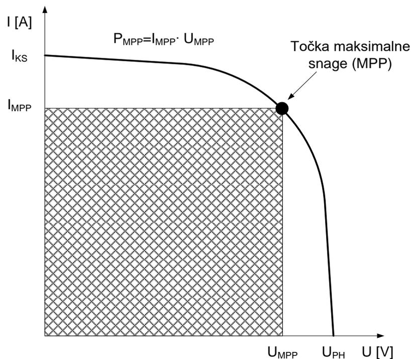
**Slika 2.5.** Strujno – naponska karakteristika fotonaponske ćelije [2]
