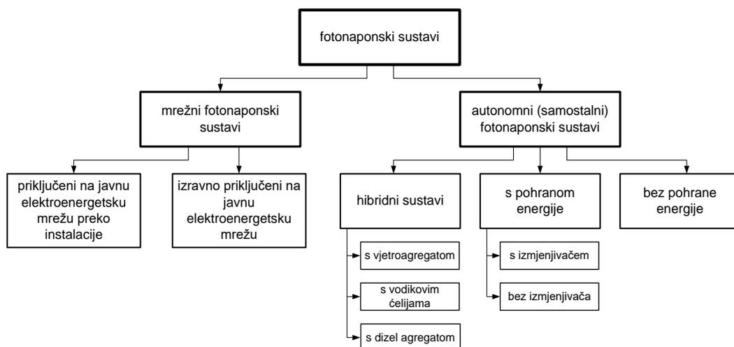
Slika 2.2. Podjela fotonaponskog sustava [2]
