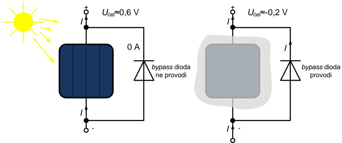
Slika 2.9. Shema ćelije sa prenosnom diodom [2]
