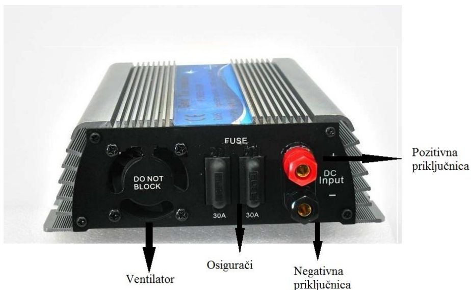
Slika 3.5. Dijelovi mikro invertera, stražnja, priključna strana
