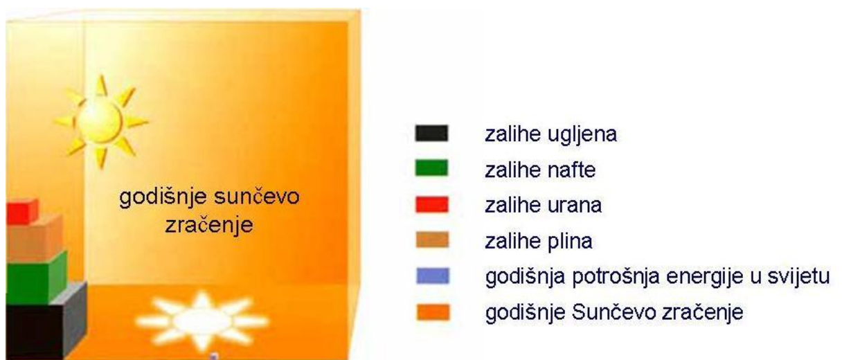
Slika 2.1. Godišnje Sunčevo zračenje na površini Zemlje u usporedbi s godišnjom potrošnjom energije u svijetu te zalihama fosilnih i nuklearnih goriva [1]
