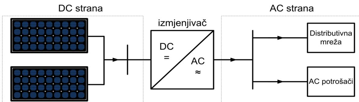
*Slika 2.10. Nadomjesna shema fotonaponskog sustava spojenog na mrežu [2]*
