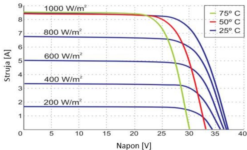
**Slika 3.1.** Strujno - naponske karakteristike modula Bisol BMO 250 [5]
