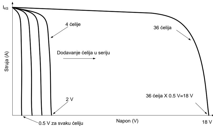
**Slika 2.6.** Strujno naponska karakteristika modula spojenih u seriju [2]
