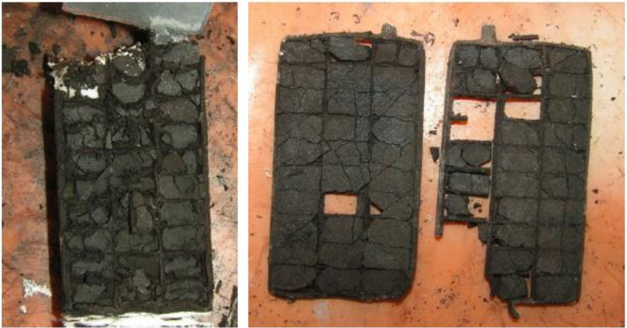
Slika 3.2. Frakcioniranje pozitivne aktivne mase [3]
