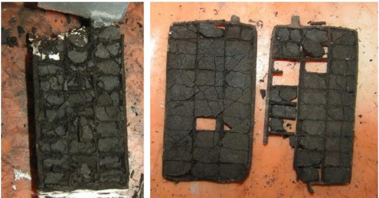
Slika 3.2. Frakcioniranje pozitivne aktivne mase [3]
