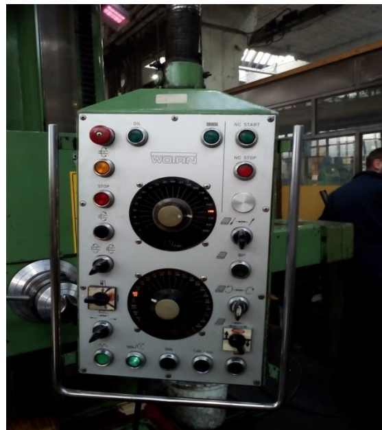
Slika 4.25. Upravljačka ploča borverka, (Fotografirano 12.11.2016.)
