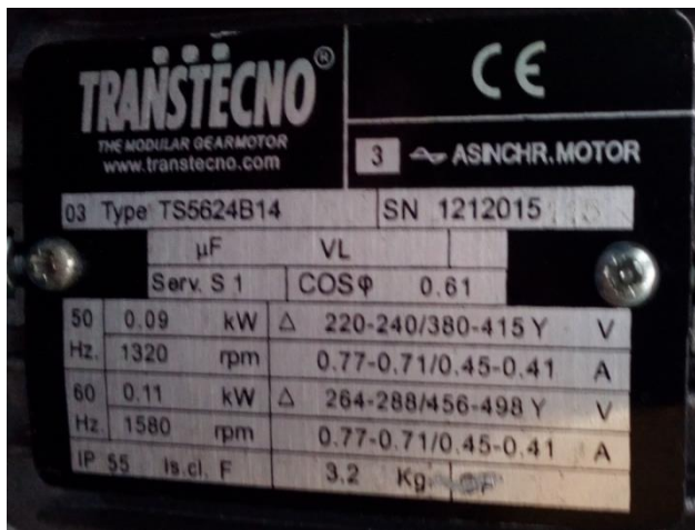
Slika 4.16. Natpisna pločica EM za podmazivanje stroja 1, (Fotografirano 12.11.2016.)
