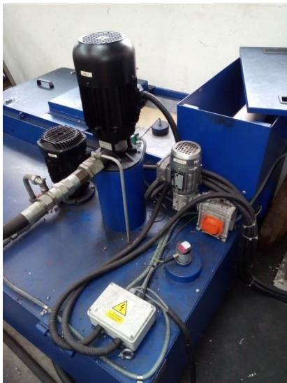
Slika 4.14. Motori za podmazivanje stroja uljem, (Fotografirano 12.11.2016.)
