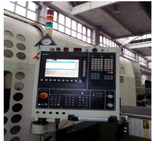
Slika 4.4. Upravljačka ploča tokarilice Karusel CNC,
