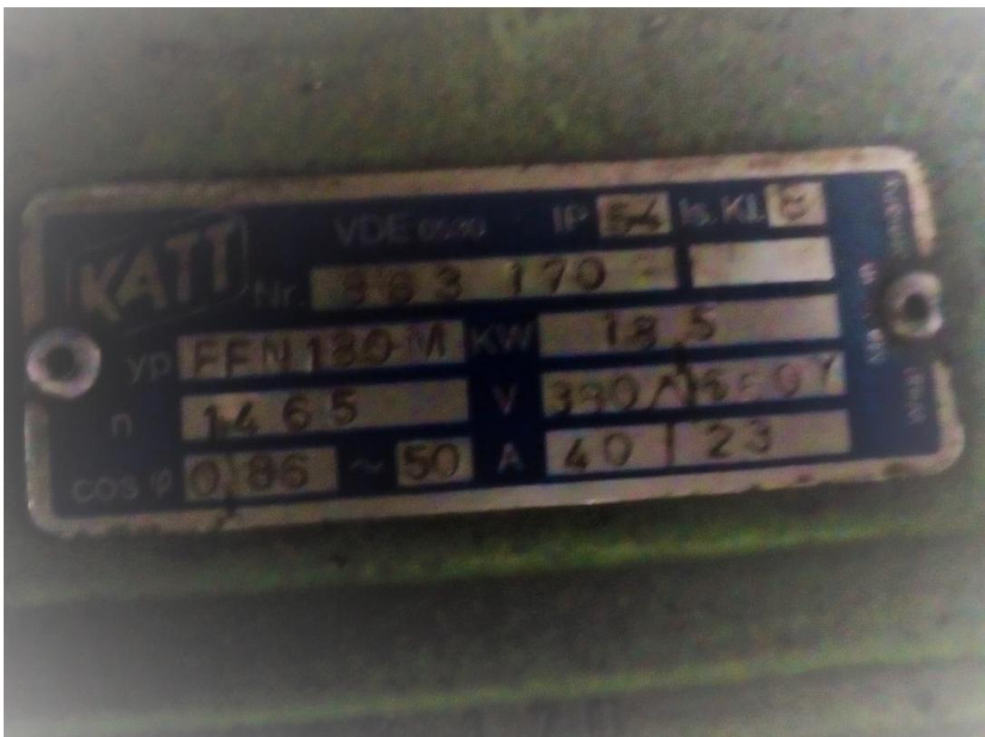
Slika 4.45. Natpisna pločica motora glavnog pogona, (Fotografirano 12.11.2016.)
