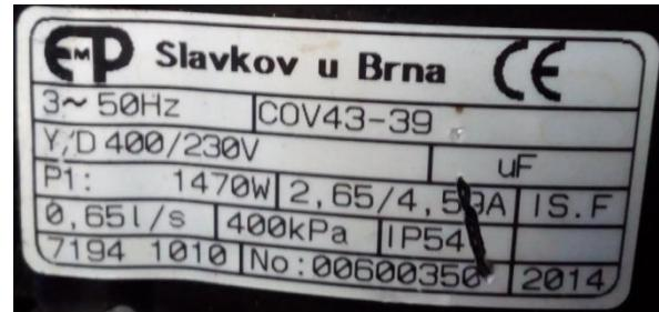
Slika 4.17. Natpisna pločica EM za podmazivanje stroja 2, (Fotografirano 12.11.2016.)
