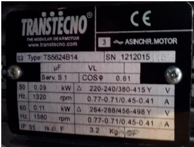
Slika 4.16. Natpisna pločica EM za podmazivanje stroja 1, (Fotografirano 12.11.2016.)
