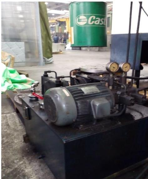
Slika 4.5. EM koji pogoni pumpu za centralno podmazivanje stroja,
