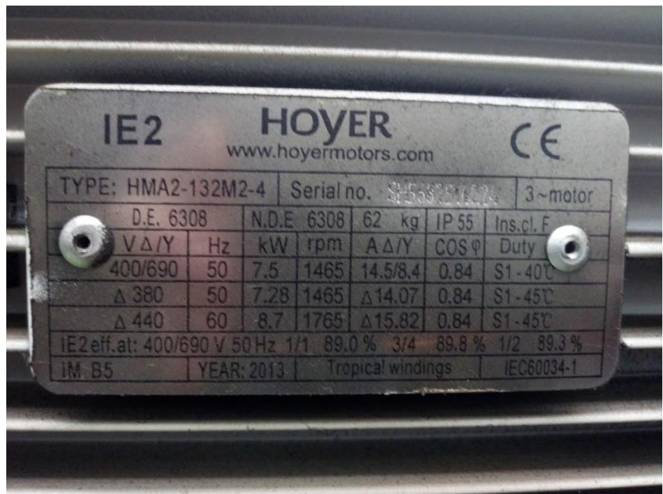
Slika 4.40. Natpisna pločica glavnog pogonskog motora stroja za dubljenje utora zupčanika,
