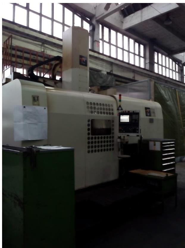
Slika 4.1. Tokarilica Karusel CNC, (Fotografirano 12.11.2017.)
