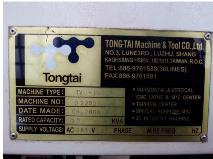
Slika 4.2. Natpisna pločica tokarilice Karusel CNC, (Fotografirano 12.11.2017.)
