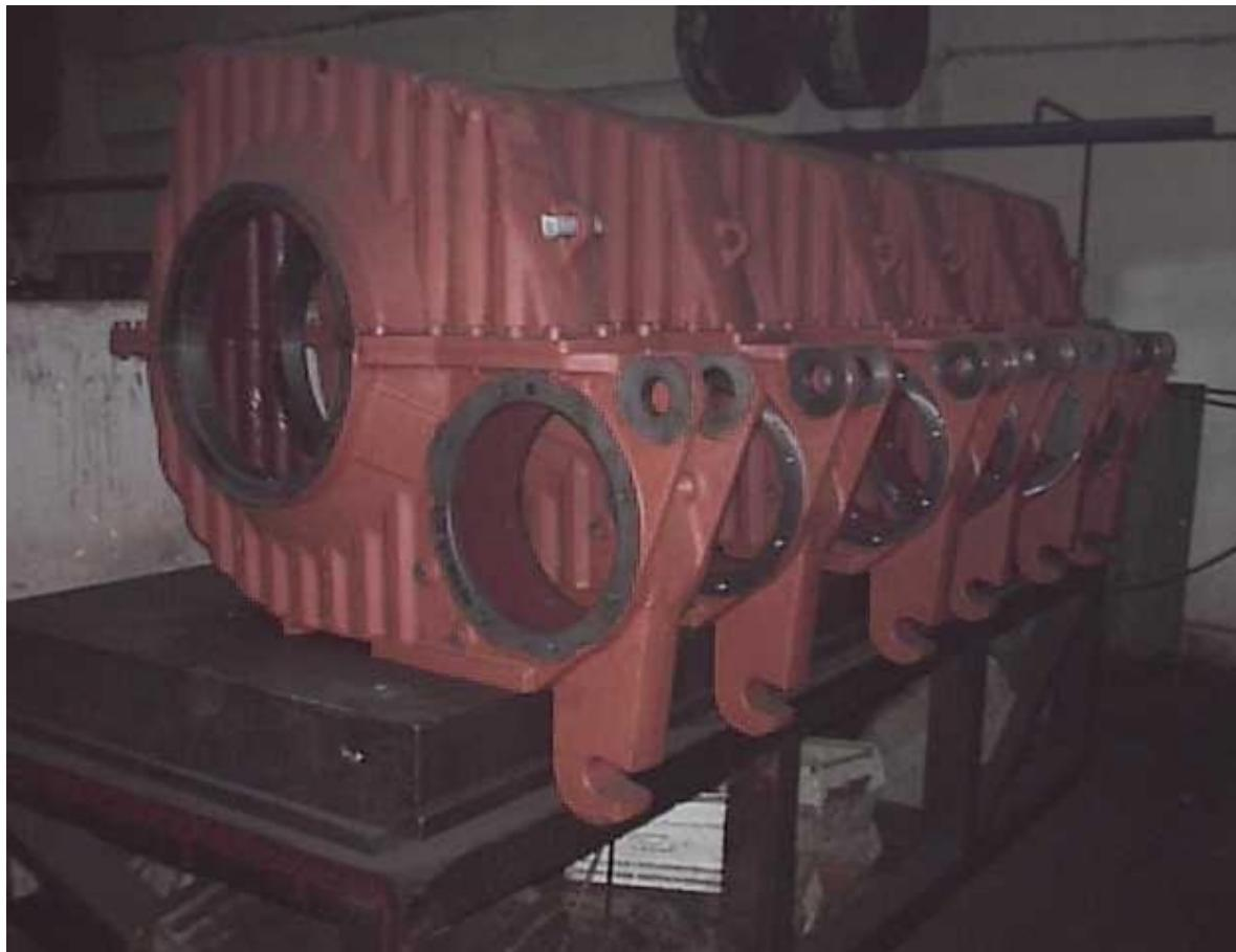
Slika 2.1. Strojno obrađeno kućište reduktora, (Preuzeto iz [4])
