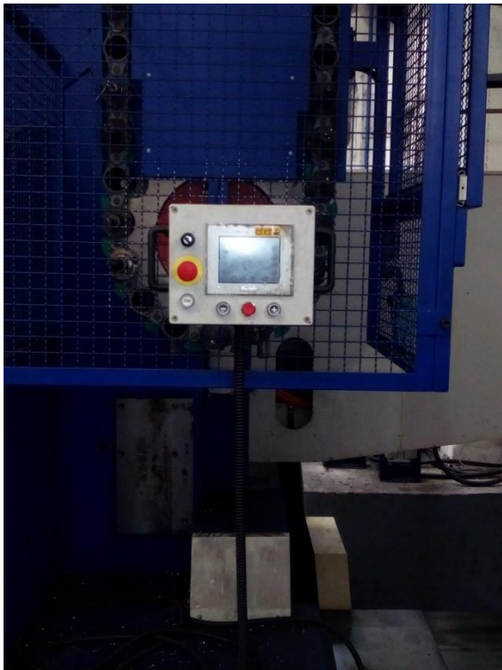
Slika 4.18. Revolver za držanje alata potrebnih za izradu pozicija, (Fotografirano 12.11.2016.)
