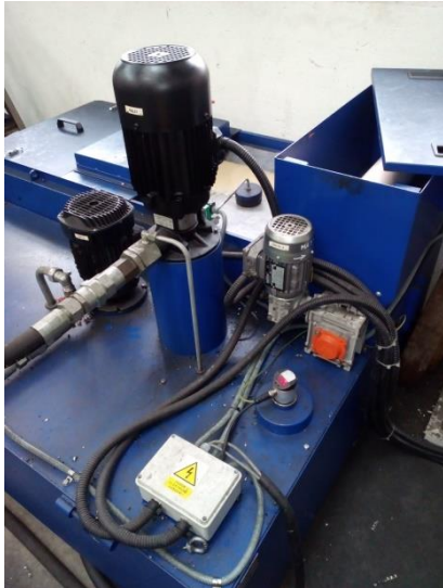
Slika 4.14. Motori za podmazivanje stroja uljem, (Fotografirano 12.11.2016.)
