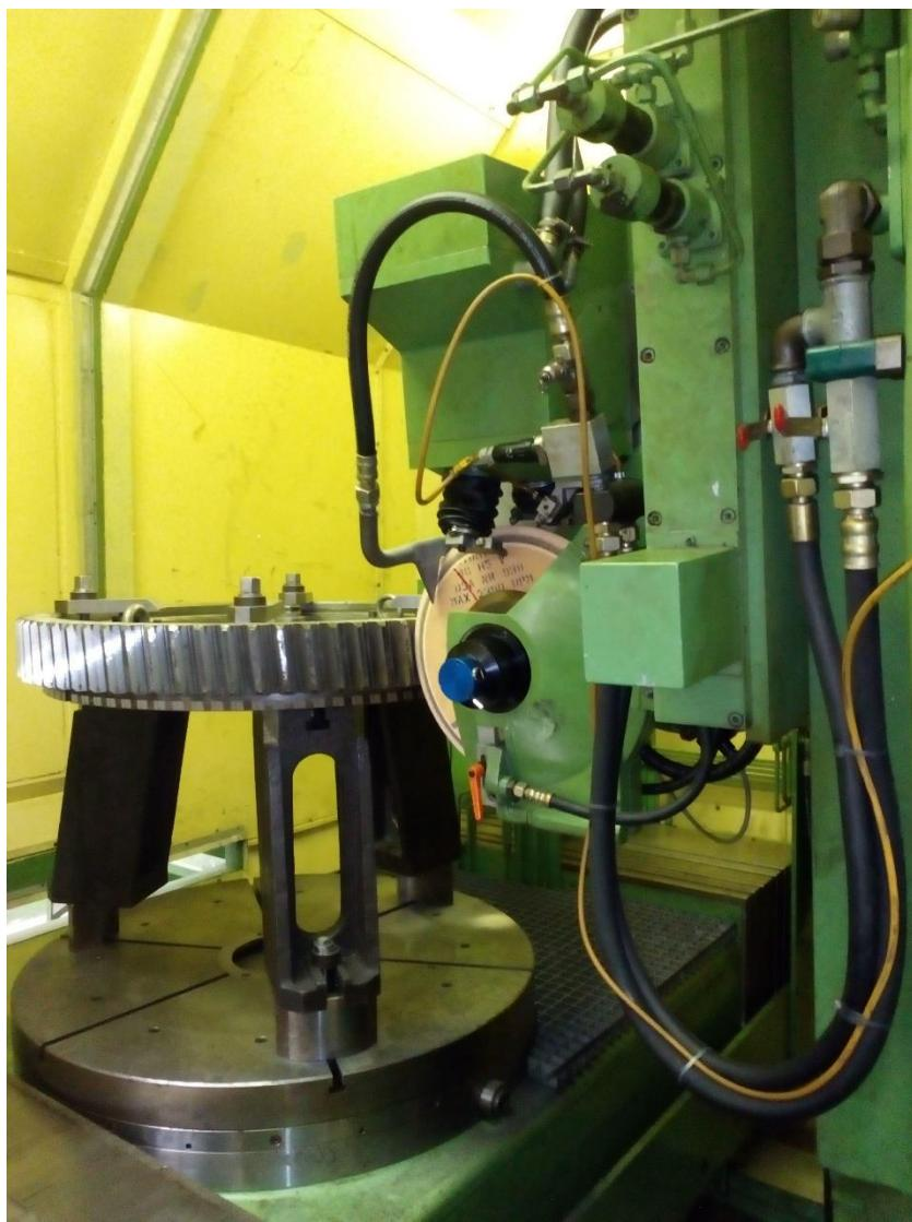
Slika 4.44. Stroj za brušenje zubi zupčanika, (Fotografirano 12.11.2016.)
