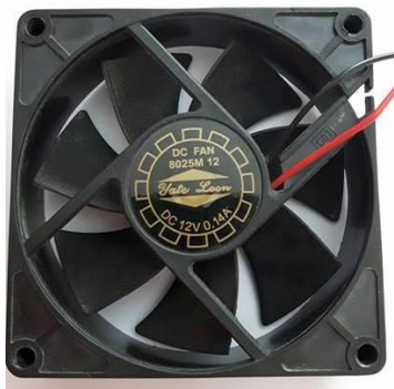
Slika 4.1.: DC motor 12V, 0.14A
