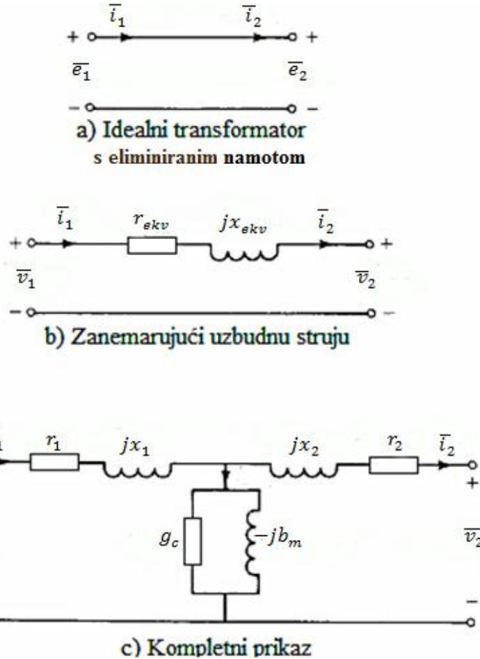
Sl. 4.2. Jedinični nadomjesni krugovi jednofaznog dvonamotnog transformatora
