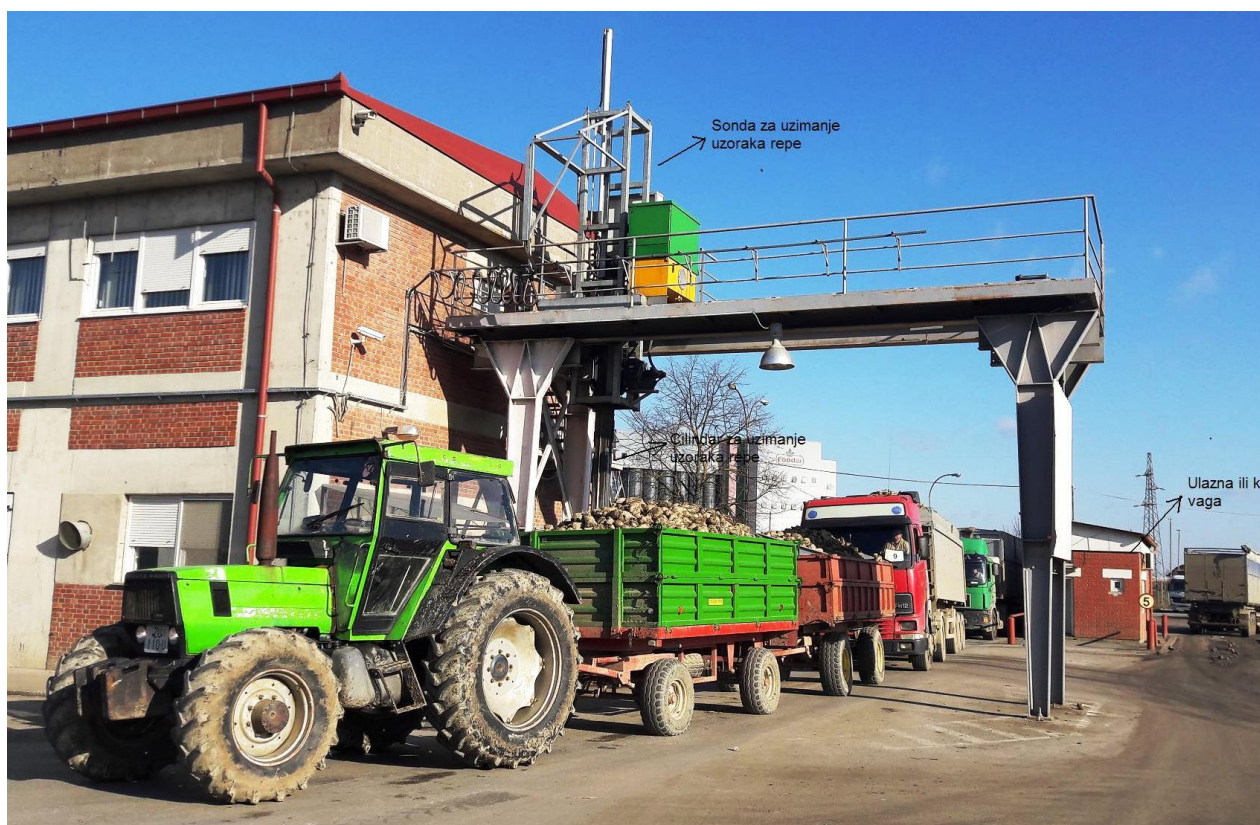
Slika 4.1 Uzimanje uzoraka repe iz prijevoznog sredstva pomoću sonde
