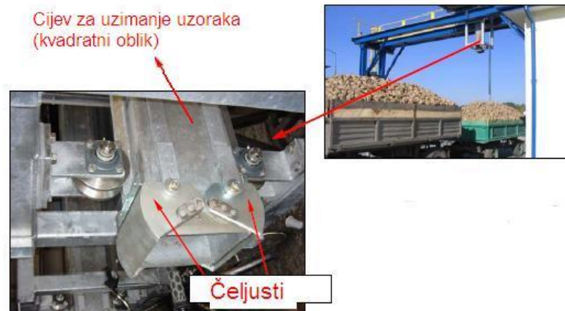
Slika 5.5 Čeljusti sonde za uzimanje uzoraka [2]
