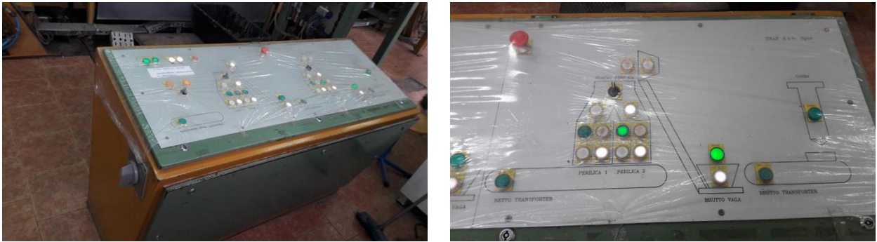
Slika 5.2 Razvodni (upravljački) pult za automatsku liniju za uzorkovanje repe
