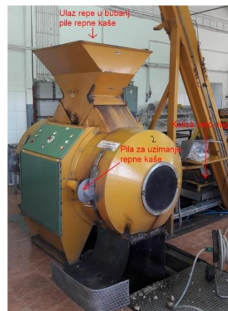
Slika 4.7 Neto vaga i pila repne kaše
