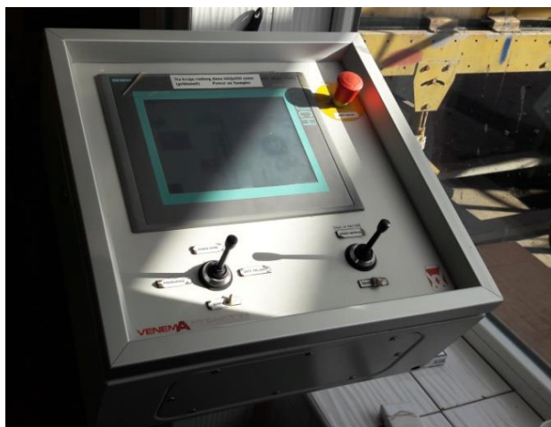
Slika 4.2 Upravljačka kutija za sondu
