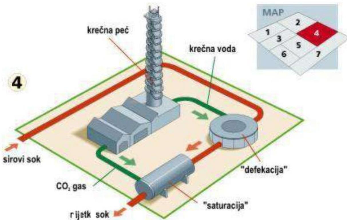
Slika 3.5 Proizvodnja vapnenog mlijeka i plina CO<sub>2</sub> u vapnenoj peći i čišćenje soka na saturaciji [1]
