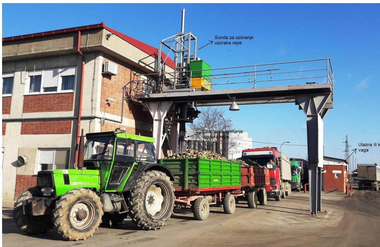
**Slika 4.1** Uzimanje uzoraka repe iz prijevoznog sredstva pomoću sonde
