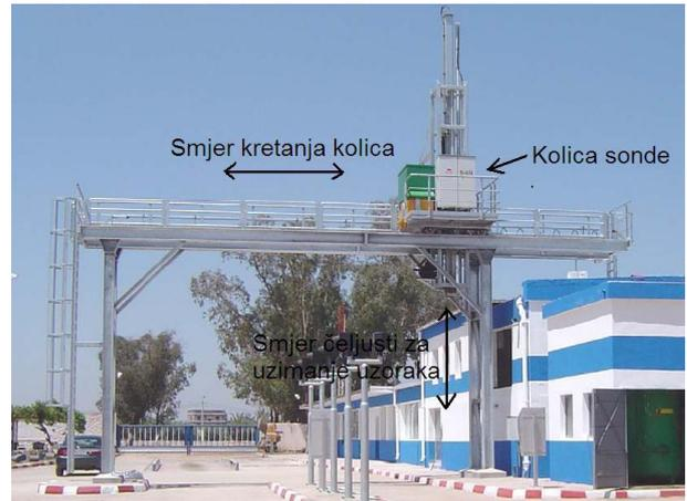
Slika 5.4 Nosiva konstrukcija sonde [2], [5]
