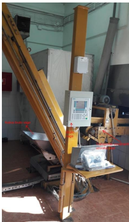
Slika 4.4 Transportna traka i bruto vaga
