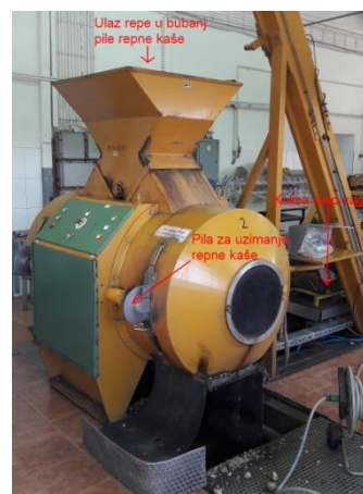
Slika 4.7 Neto vaga i pila repne kaše
