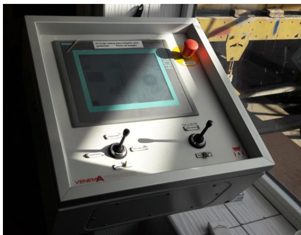
Slika 4.2 Upravljačka kutija za sondu
