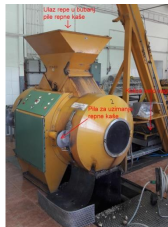
Slika 4.7 Neto vaga i pila repne kaše
