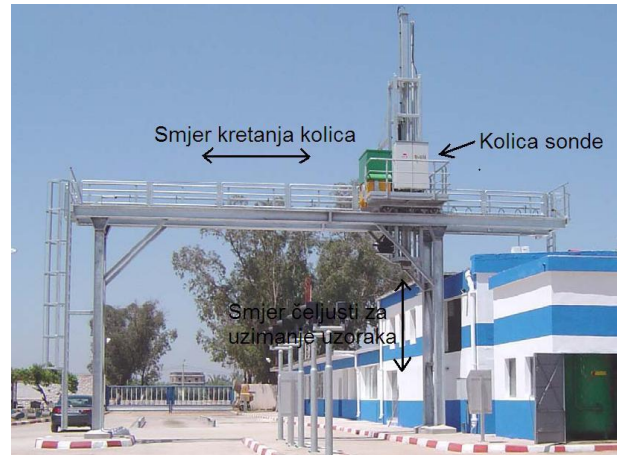
Slika 5.4 Nosiva konstrukcija sonde [2], [5]
